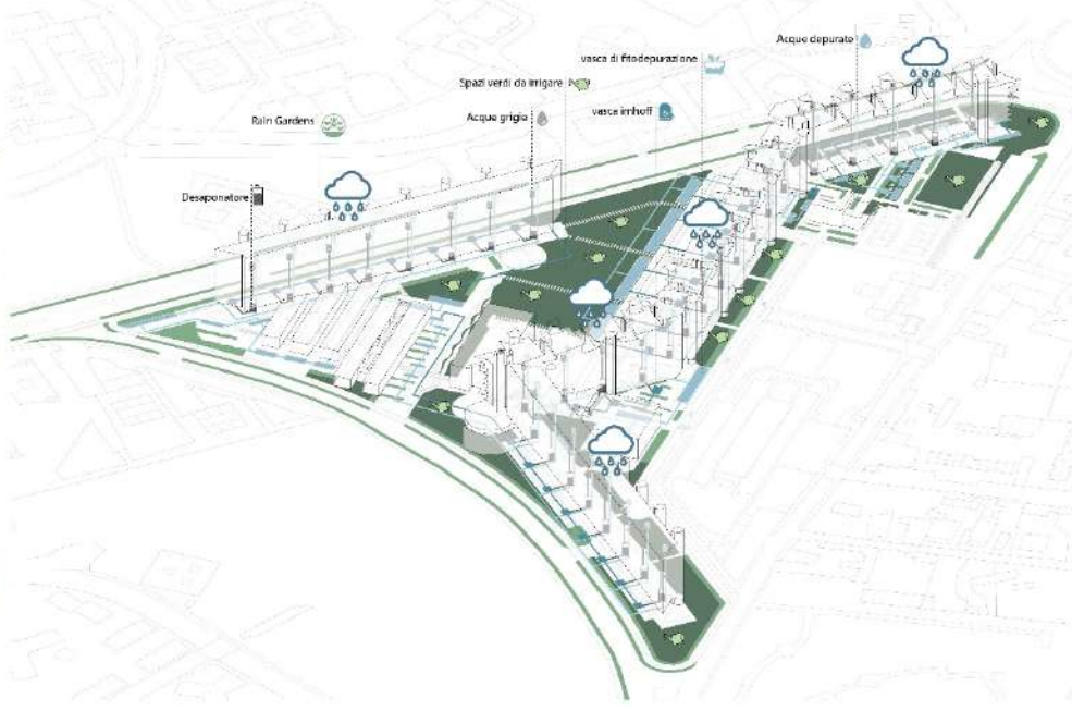
Fig. 8 La rete dei rifiuti caratterizzata da un sistema pneumatico di raccolta e la rete dell'acqua potabile e piovana e la loro gestione nell'ottica di recupero e riutilizzo adottata nel progetto di rigenerazione del PdZ di Vigne Nuove, a Roma.
