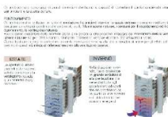
Fig. 5 Schemi funzionali relativi ai temi dell'Atrio Solare, del Vertical Farming e degli Air pipes e i sistemi bioclimatici applicati al sistema degli alloggi.
