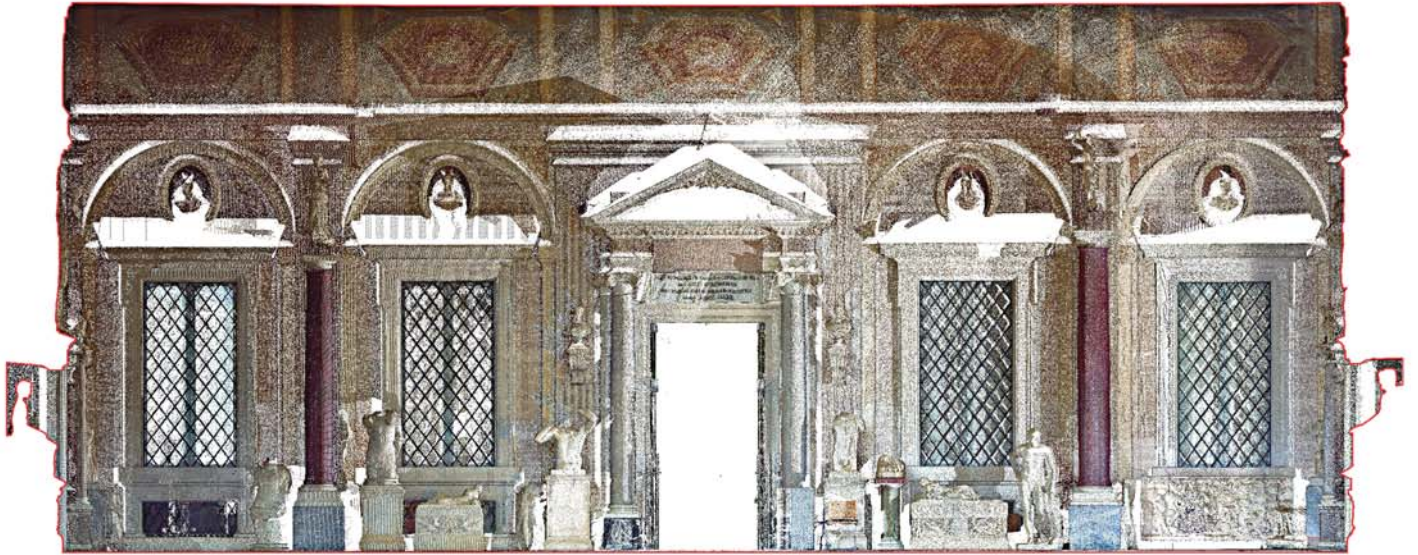
portico, prospetto nord-est sezione dal modello numerico
