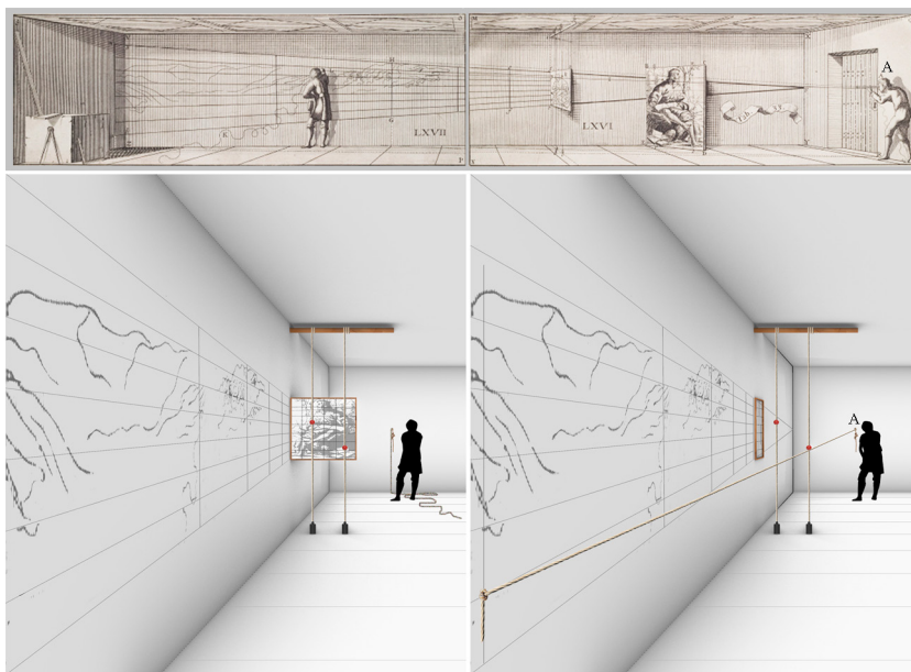
Fig. 8. Strumento descritto nelle incisioni LXVI e LXVII del Thaumaturgus Opticus da Jean François Niceron per la costruzione delle anamorfofi e ricostruzione del procedimento (elaborazione grafica di M. Salvatore).
