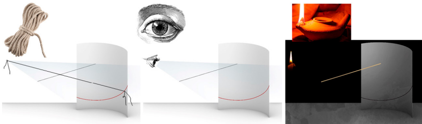
Fig. 2. Operazioni di proiezione con funi, lucerne e traguardo a vista (elaborazione grafica di M. Salvatore).
