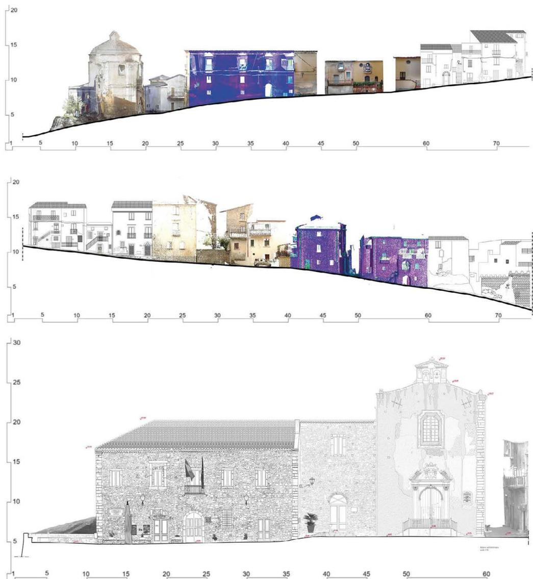
Fig. 7. Modelli 2D. In alto i fronti di via San Rocco, in basso il prospetto dell'edificio del Municipio. Elaborazione degli autori.
