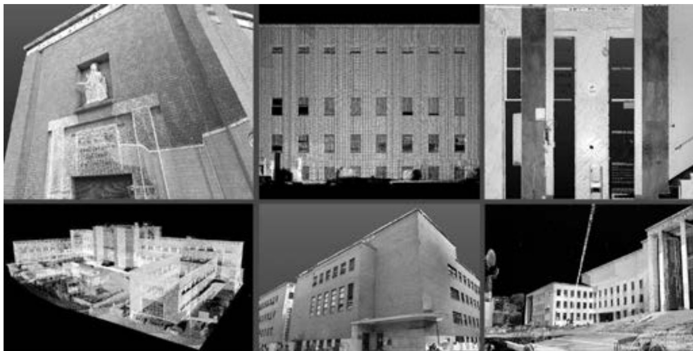
Fig.1 - Gli edifici analizzati: la Cappella della Divina Sapienza, l'Istituto di Geologia e Mineralogia, la Scuola di Matematica, l'Istituto di Botanica, l'Istituto di Fisica, il Rettorato. Modelli numerici ottenuti da scansione laser 3D e Structure from Motion.
