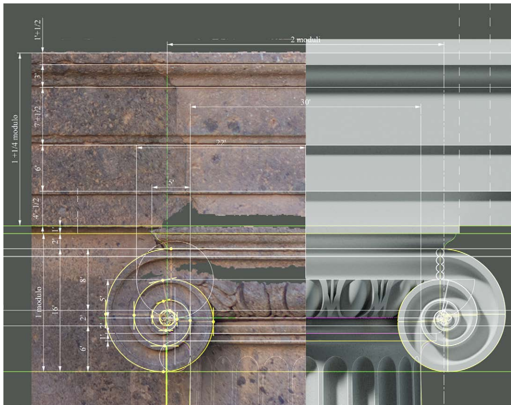
Fig. 11. Confronto proporzionale tra il modello reale e il modello teorico nel dettaglio del capitello ionico. Elaborazione degli autori.
