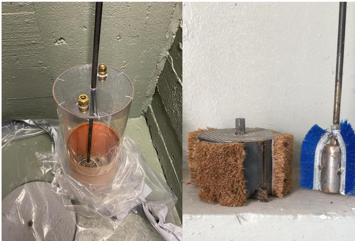
**Figura 12** – Dettaglio della calotta di protezione e delle spazzole usate per i lavaggi.
