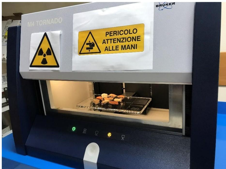
Figura 4. M4 TORNADO della Bruker usato per realizzare le analisi di micro-fluorescenza a raggi X.
