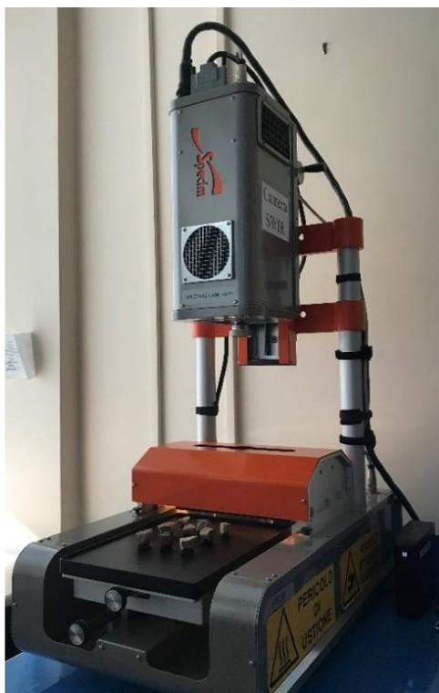
Figura 3. Architettura SWIR-HSI della Specim: SISUChema XL. Chemical Imaging Workstation.
