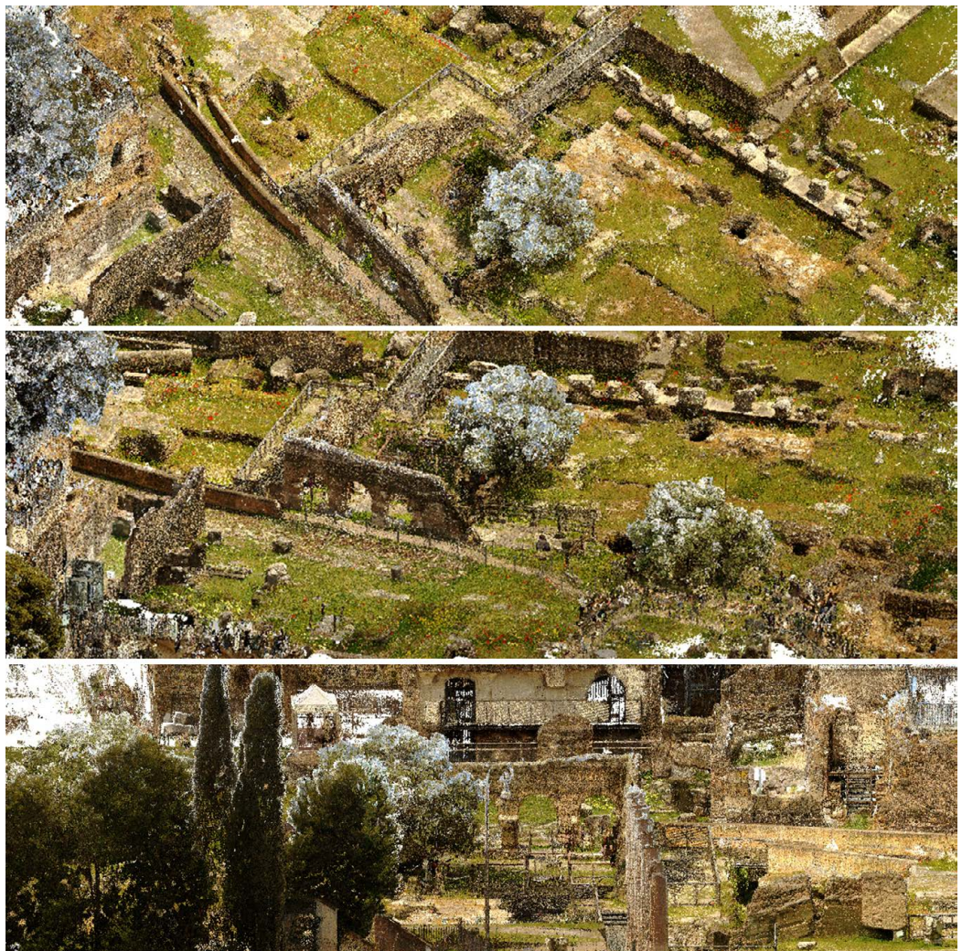
Fig. 7. Viste della nuvola di punti generata da acquisizione mediante Laser Scanner 3D.
