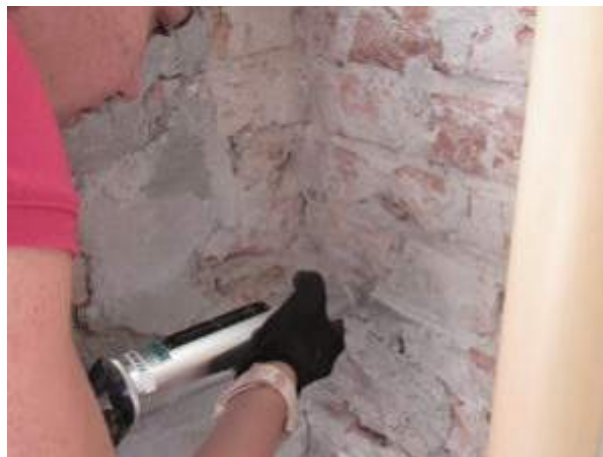
Fig. 19. Sclerometric test. From P. Rocchi, C. Piccirilli, Manuale della Diagnostica , Edizioni Kappa, Roma 1999.
