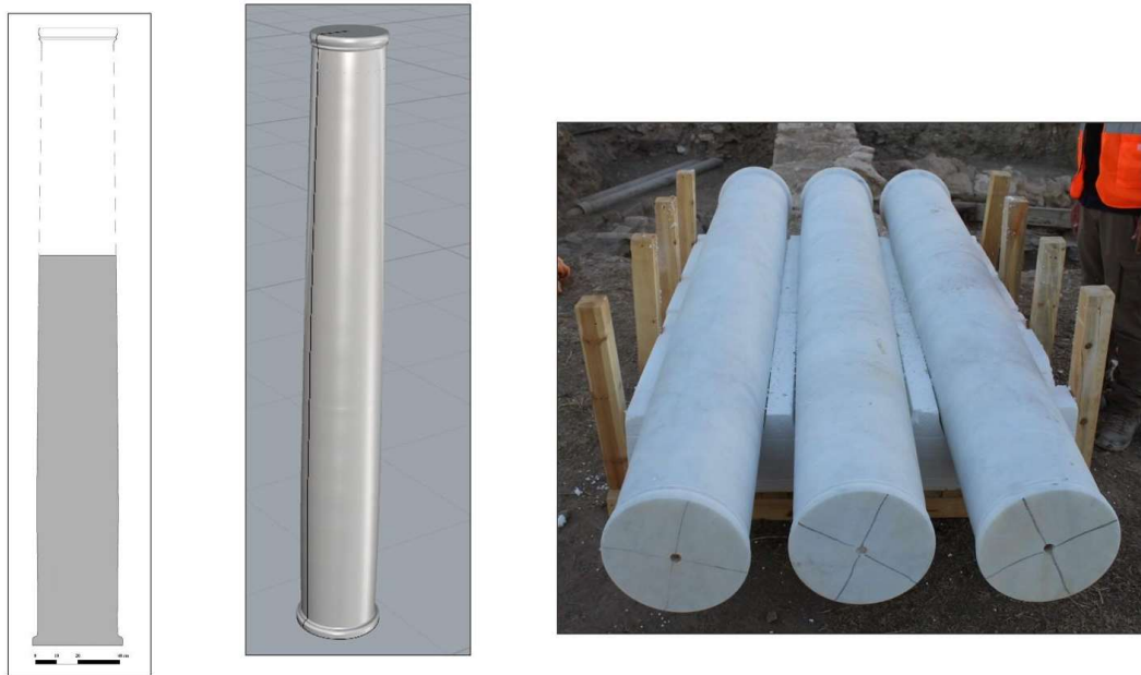
Figura 65, fusti del primo ordine, da sinistra un rilievo (elaborato da L. Campagna, Archivio MAIER), al centro l'elemento estruso, a destra il taglio laser su modello 3D adoperato per l'anastilosi (2025, Archivio MAIER).
