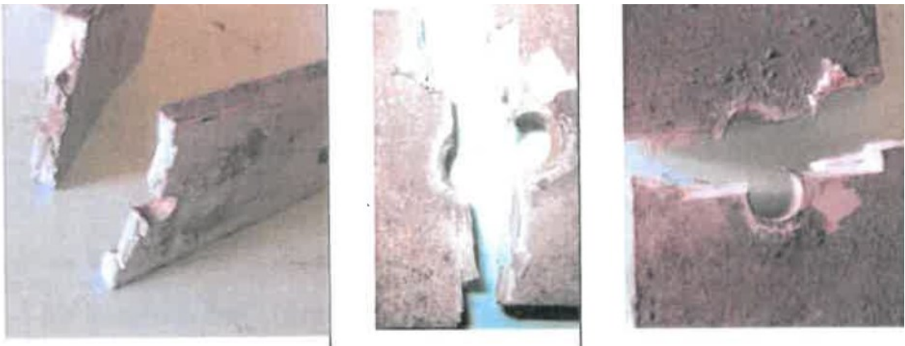
Figura 3.36 – Casi di rottura delle forcelle di aggancio del rilevatore CE-KFS sotto le vetture tranviarie
