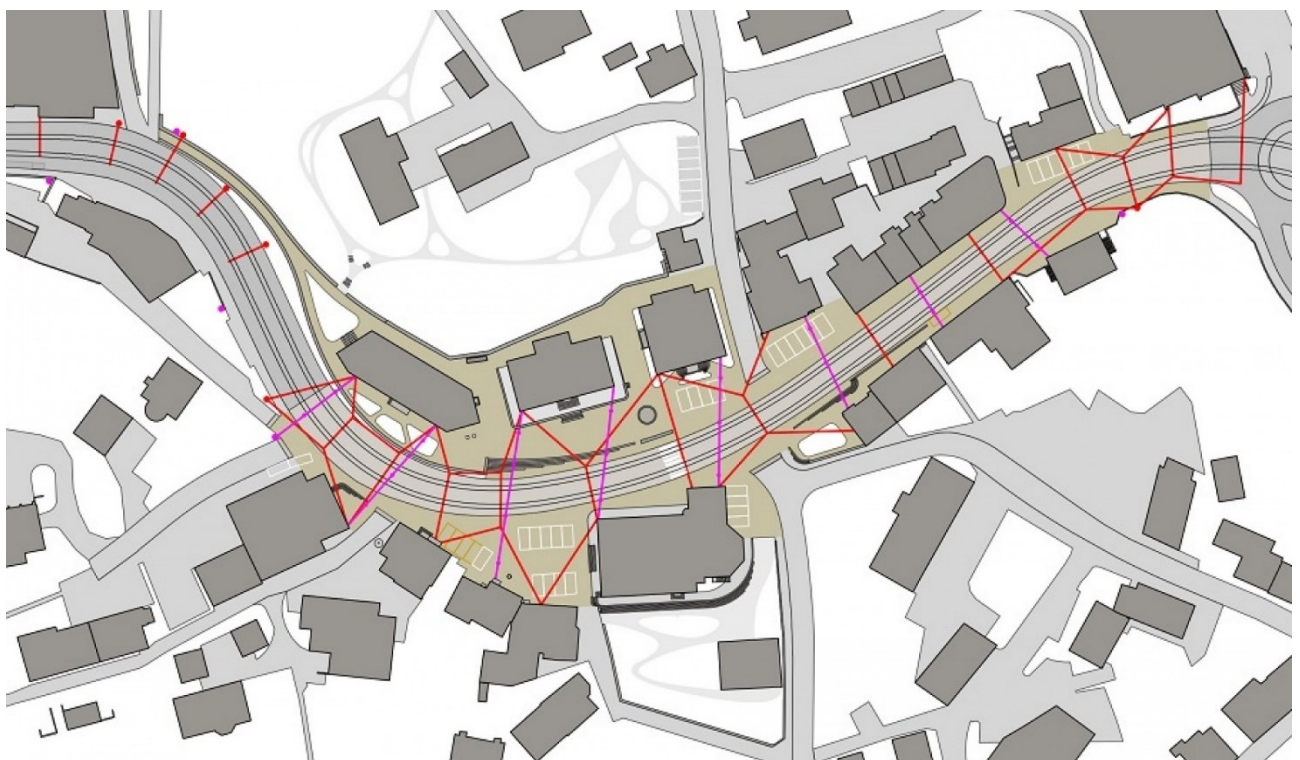
Figura 3.15 - Nuovo tracciato urbano di Teufen, disposizione dei sostegni della linea di contatto
