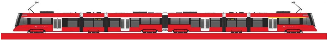
Figura 3.5 - Profilo del nuovo rotabile ABe 8/12 di Stadler
