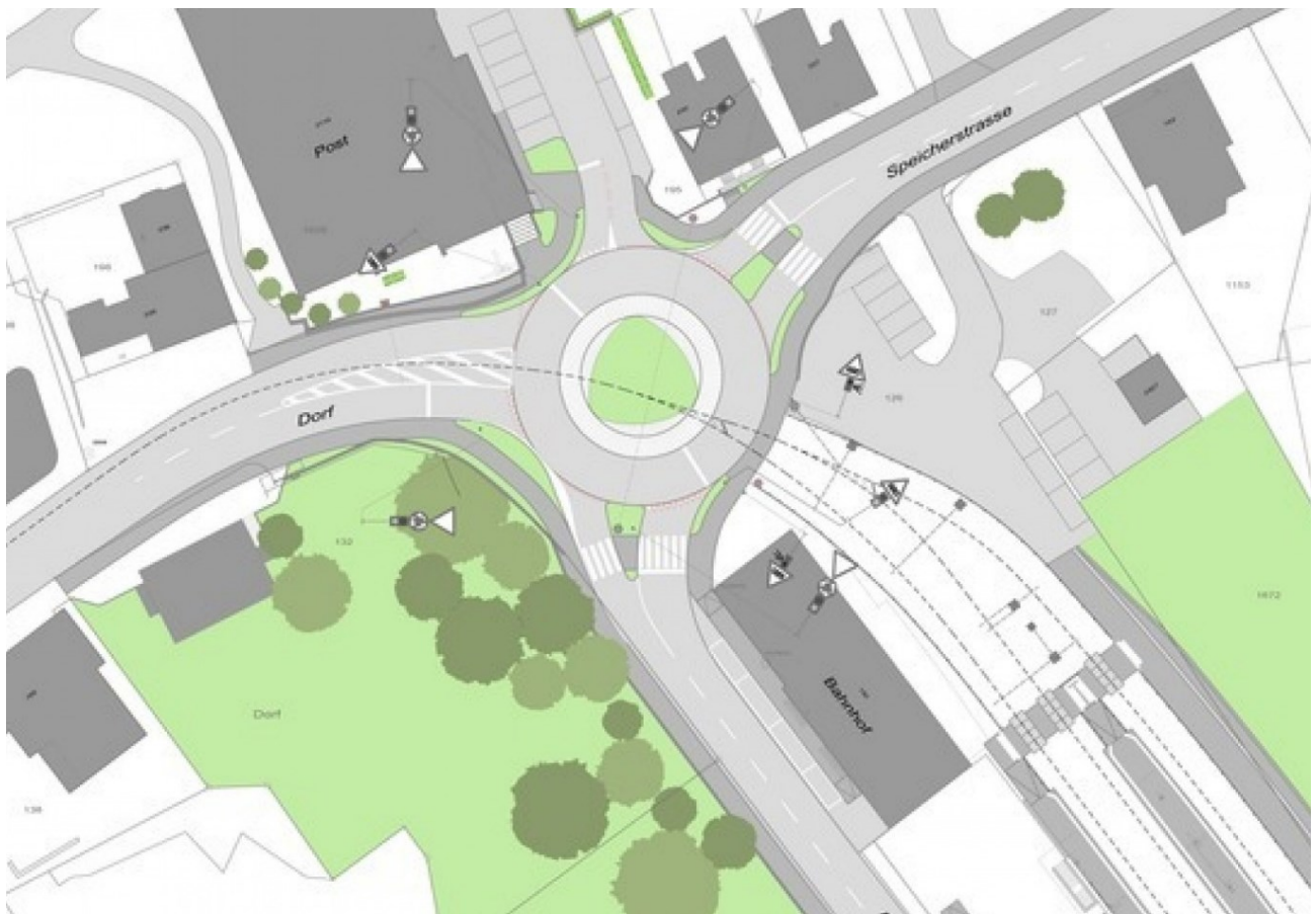
Figura 3.15 - Nuovo tracciato urbano di Teufen, disposizione dei sostegni della linea di contatto
