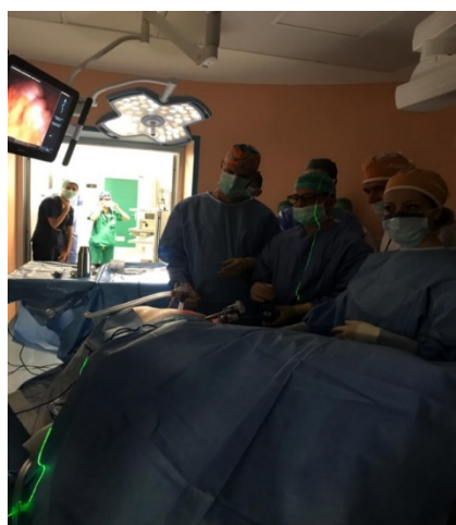
Figura 8 - Sistema laser per il centraggio del robot sul trocar per l'ottica
