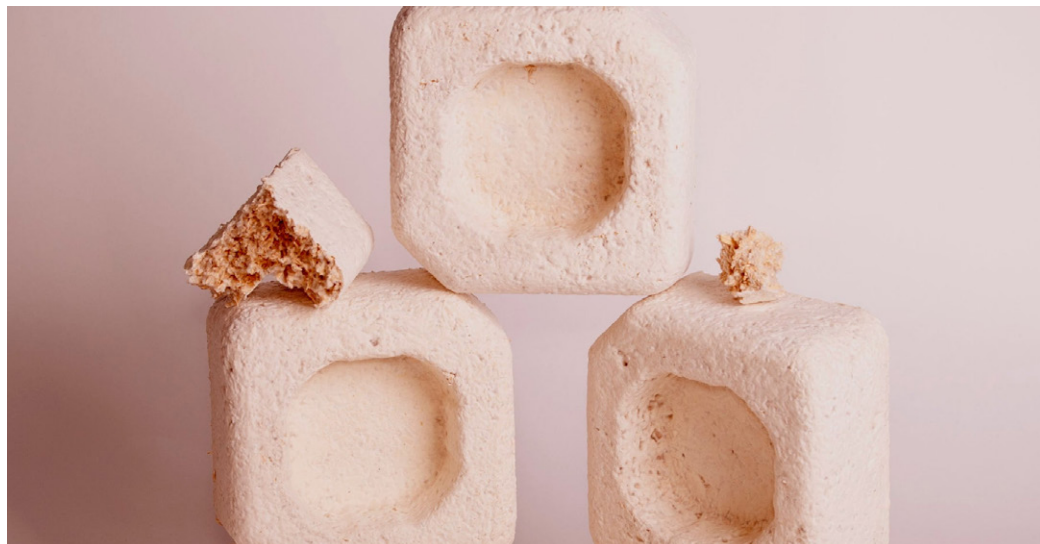
Fig. 1 - Mushroom® Packaging, Ecovative, 2012. Packaging realizzati con il micelio dei funghi. Quest'ultimo cresce all'interno di stampi contenenti spore, materiale di supporto (segatura) e nutrimento (scarti agro-alimentari) permettendo la produzione di packaging per scopi multipli.
