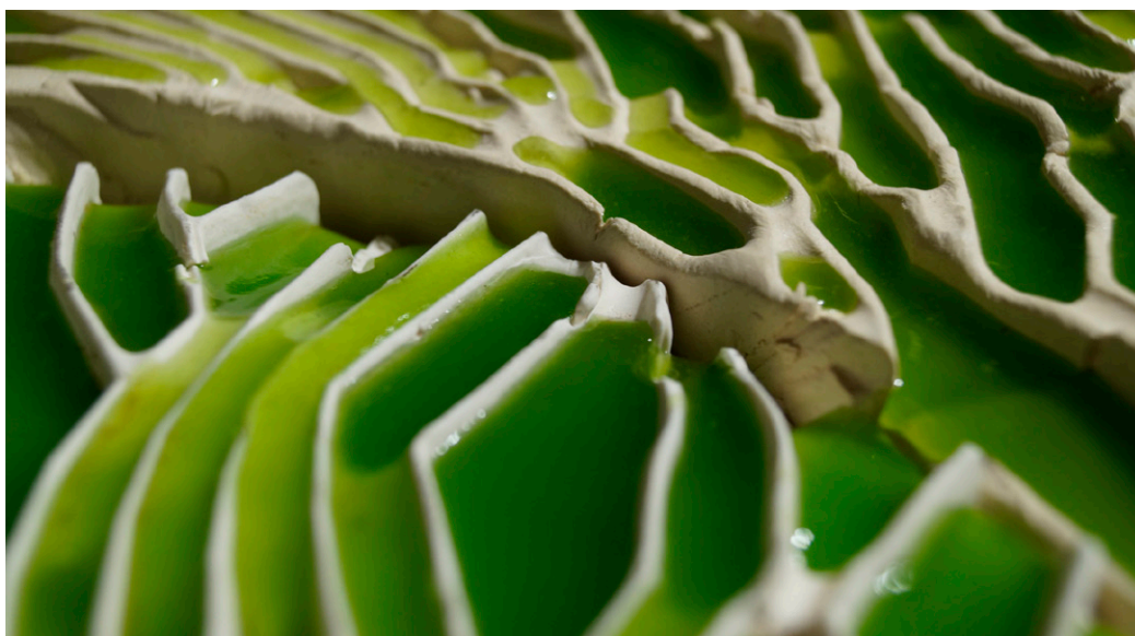
Fig. 6 – Algae Tiles, Bio-ID Lab & Bartlett School of Architecture, 2019. Rivestimento per edifici in ceramica e ricoperto di idrogel contenente alghe. Quest'ultime purificano l'aria attraverso la fotosintesi clorofilliana ed assorbono acqua canalizzandola lungo percorsi ottimizzati.
