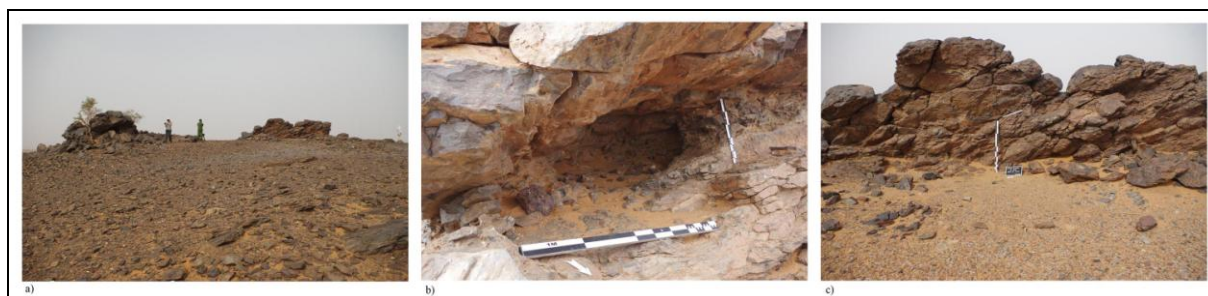
Fig. 13 : Front de taille et mine souterraine à l'Ouest de Gleibât es Sehb : a) vue générale en direction du sud-ouest de la mine souterraine (à gauche) et du front de taille (à droite), b) vue de détail de la mine souterraine et du boyau orienté sud-est/nord-ouest suivant la minéralisation de cuivre, c) vue de détail du reliquat de front de taille, qui originalement était relié à la cavité ; au centre du front de taille la veine de cuivre d'une puissance de 20 cm, orientée sud-nord selon un pendage de 42°, a complètement été exploitée.
