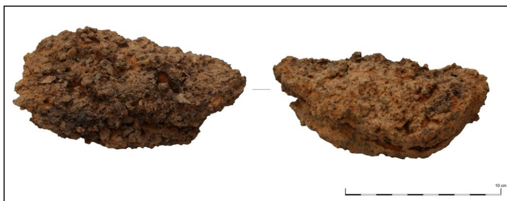
Fig. 24 : culot massif de fond de four (88,12 g.) découvert dans le carré B2 lors de la fouille du site métallurgique d'El-Jemel-Lebyad.
