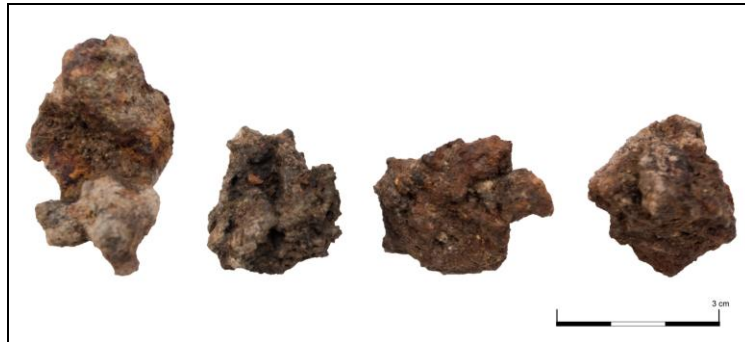
Fig. 38 : Scories riches en métal, pesant au total 53g, découvertes au fond du four de réduction du camp
