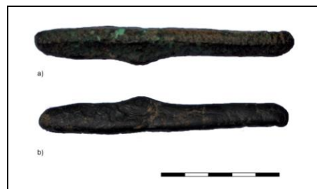
Fig. 31 : Lingot (72 g) en cuivre (93,3% Cu, 2,83% Mn, 2,71% Fe) découvert en 2017 au niveau du secteur de production d'objets en métal à Lemdena. a) face supérieure en contact avec le sable lors de la fonte (grains de silice vitrifiés piégés dans le métal), b) face inférieure en contact avec l'air (microstructure caractéristique d'un refroidissement rapide).
