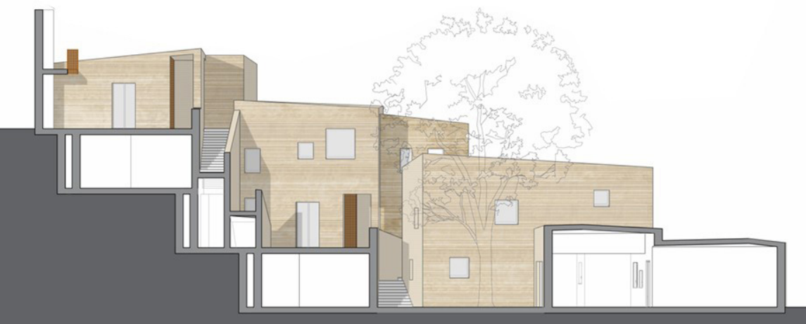
Fig 33. In alto, una sezione mostra il sistema di piazze che si configura attraverso l'inserimento di edifici articolati su più quote; A destra, uno schema chiarisce l'organizzazione spaziale del sistema, descrivendo il ruolo delle scale come dispositivi di collegamento tra i vari livelli e gli spazi pubblici. Elaborazione Alessia Morelli
