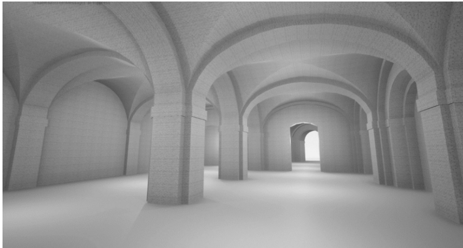
Fig. 5 – Vista del modello 3D della sala dedicata alle sculture classiche utilizzato per la simulazione di riflessioni, riverberi ed occlusioni acustiche.
