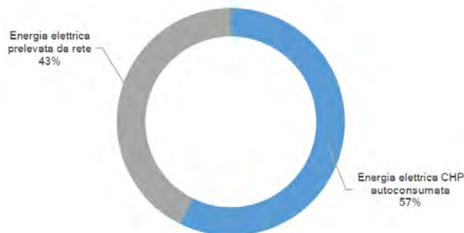
Figura 135 - Copertura fabbisogno energia elettrica.
