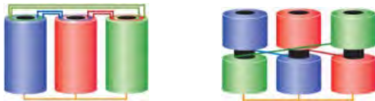
Figura 42- Autotrasformatori: collegamenti tra avvolgimenti.
