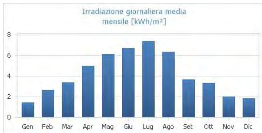
Figura 121 - Irradiazione giornaliera media mensile sul piano orizzontale [kWh/m 2 ] - Fonte dei dati: UNI 10349:2016 - Stazione di rilevazione: Montefiascone.
