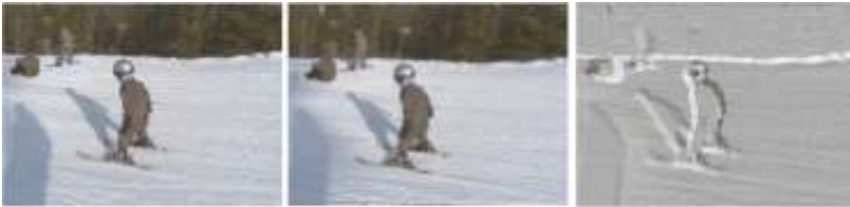
Figura 10.30: Due fotogrammi consecutivi, e la differenza tra i rispettivi valori di luminanza
