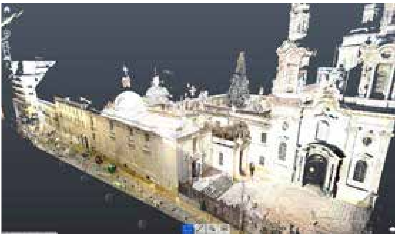
Fig. 61 – Visualizzazione della nuvola di punti generata con Laser scanner Focus 70 .
