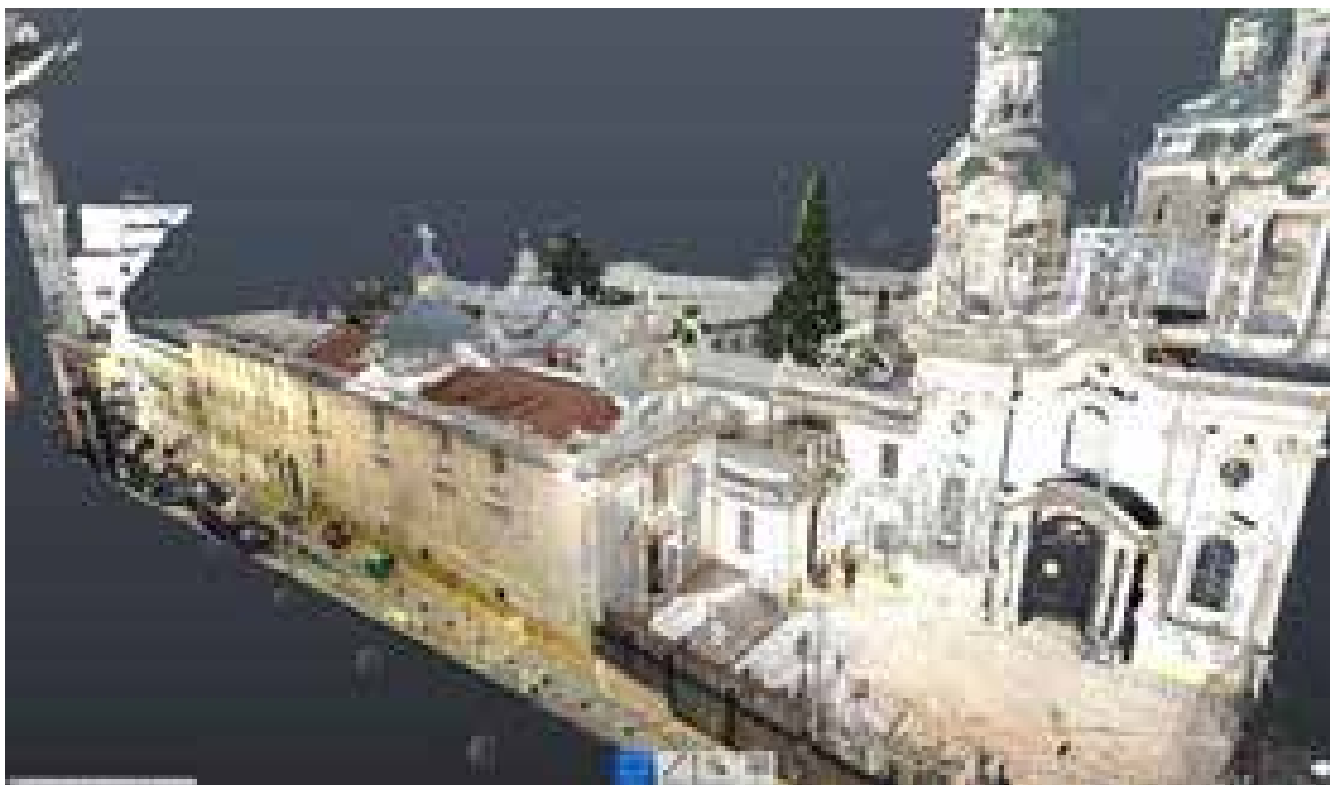
Fig. 66 – Visualizzazione della nuvola di punti integrata tra acquisizione TLS e fotogrammetria da drone.
