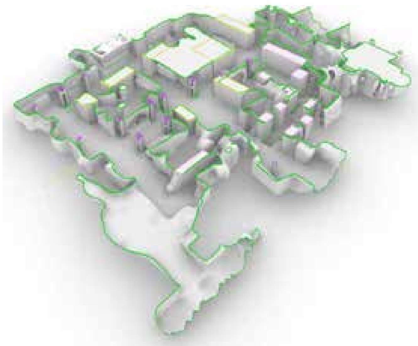
Fig. 177 – Murature di spessore variabile, volte deformate, pilastri irregolari e superfici scavate direttamente nella roccia richiedono la creazione di famiglie personalizzate, spesso modellate a partire da profili estratti direttamente dalle sezioni della nuvola di punti.
