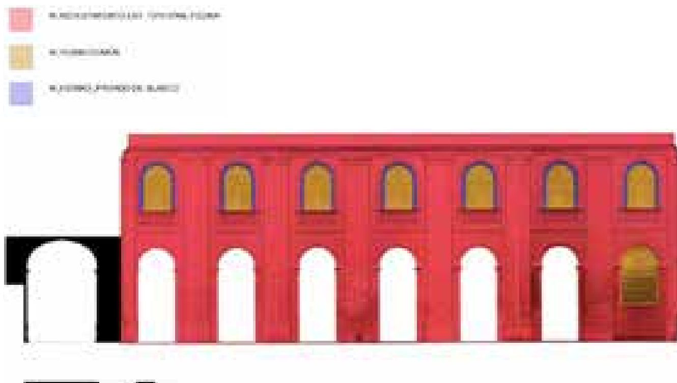
Fig. 73 – Materiali applicati su un prospetto del chiostro.
