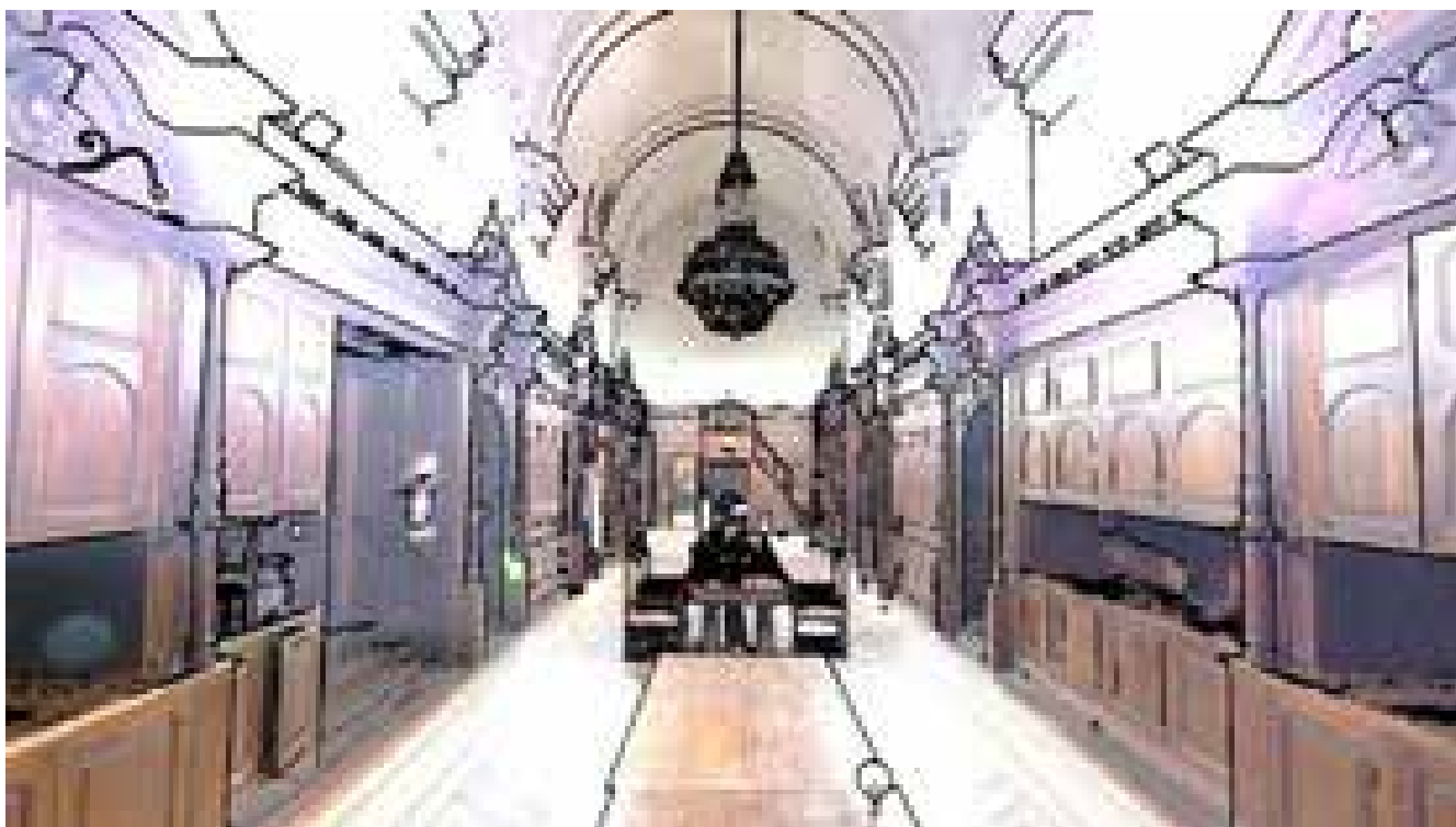
Fig. 60 – Panorami sferici generati con il Laser scanner per facilitare l'operazione di riscontro dei punti omologhi.
