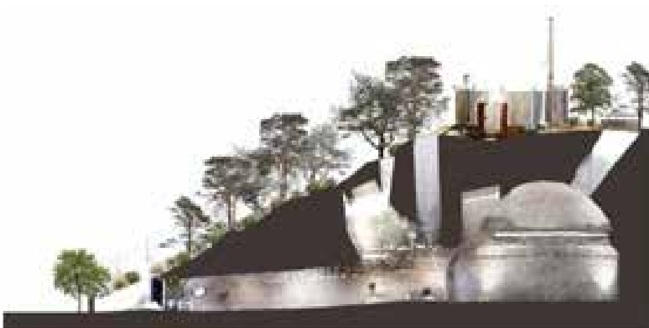
Fig. 191 – Ortofoto che consente di leggere le trasformazioni che nel tempo hanno interessato il Mausoleo di Monte del Grano. Sezione Est – Ovest sull’aula centrale e il corridoio di accesso.
