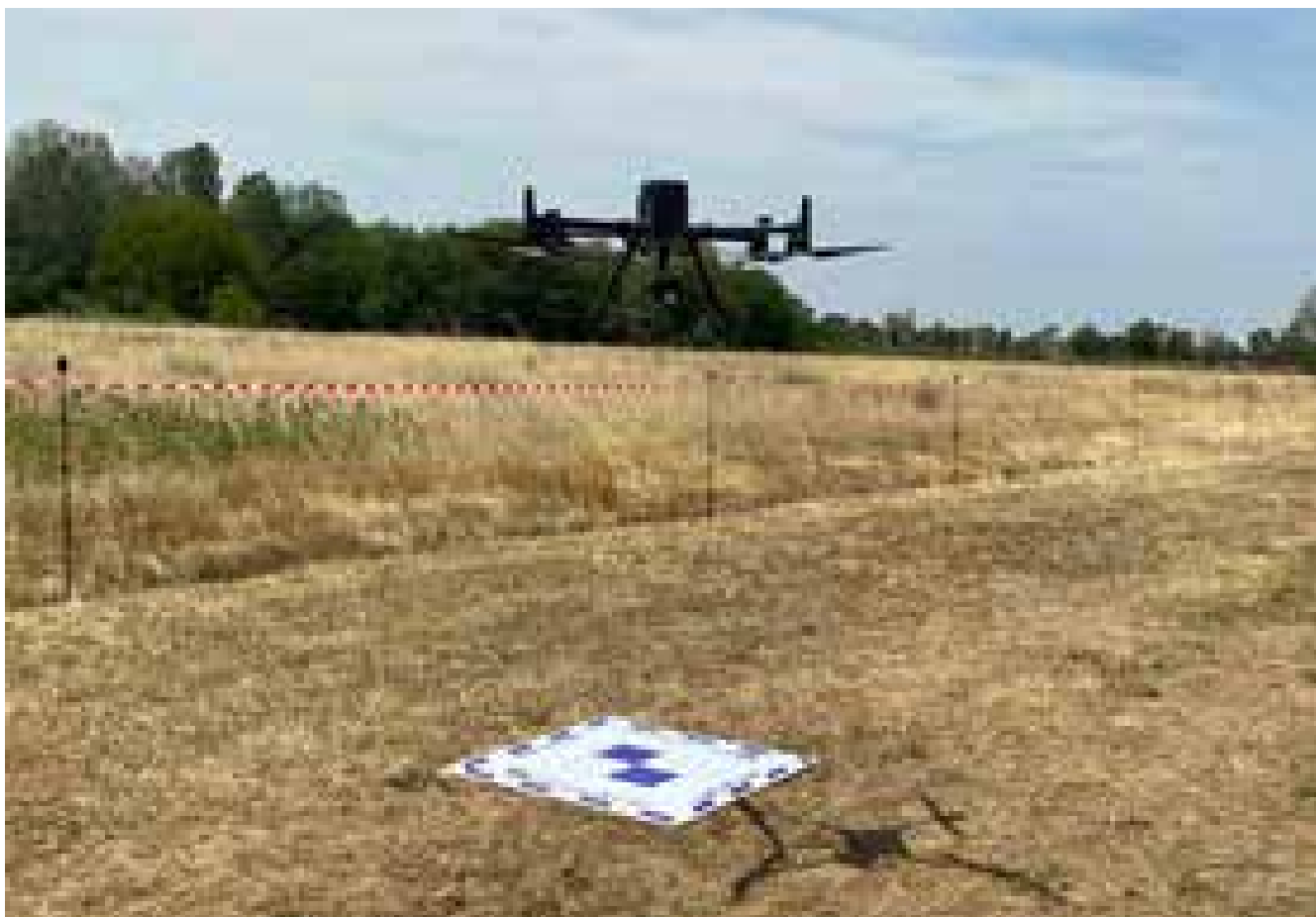
Fig. 12 – Acquisizione mediante Fotogrammetria da drone.
