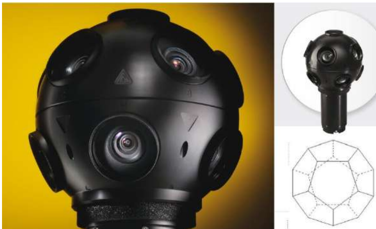
Figura 3.6. Fotocamera sferica Dodeca 2369. La camera è assimilabile ad un dodecaedro con gli obiettivi posti sulle facce.
