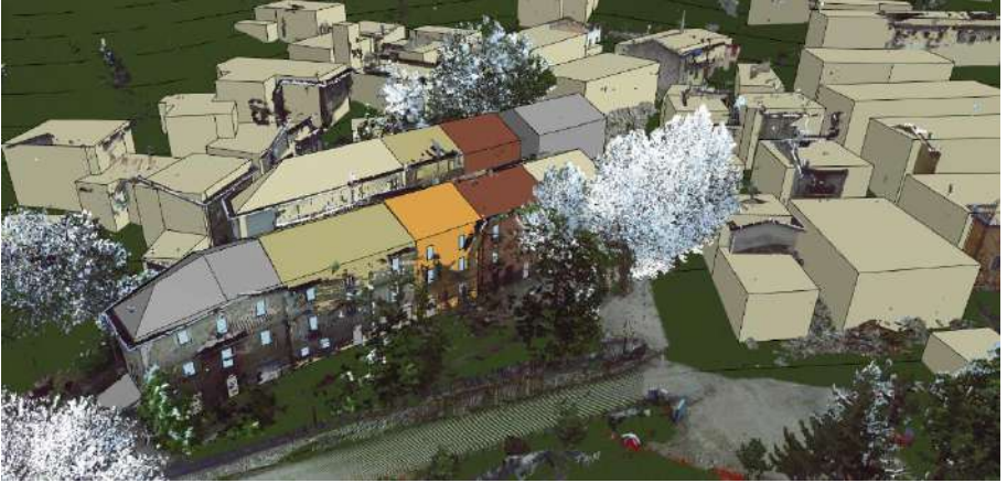
Figura 4.21. Nuvola di punti orientata sul modello sintetico per l'estrazione degli ingombri di porte e finestre. Elaborazione a cura degli architetti Mario Sacco e Michele Calvano.
