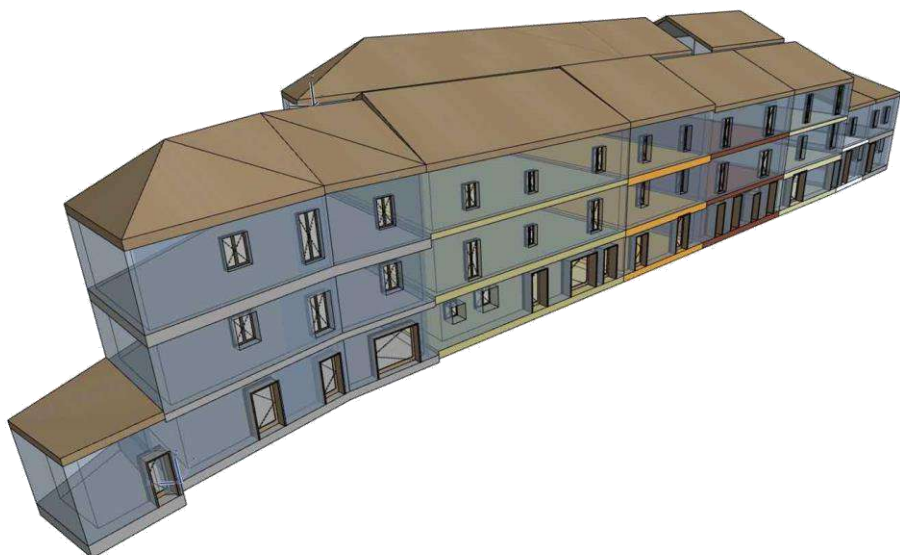
Figura 4.20. Modello dettagliato dell'isolato scelto di Grisciano, risultato della procedura DIM.
