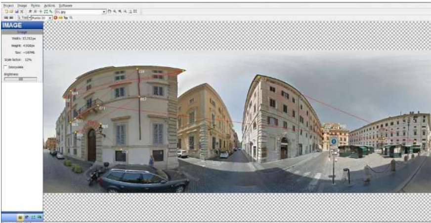
Figura 3.13. Interfaccia del software Sphera di Gabriele Fangi. Scelta dei punti omologhi.
