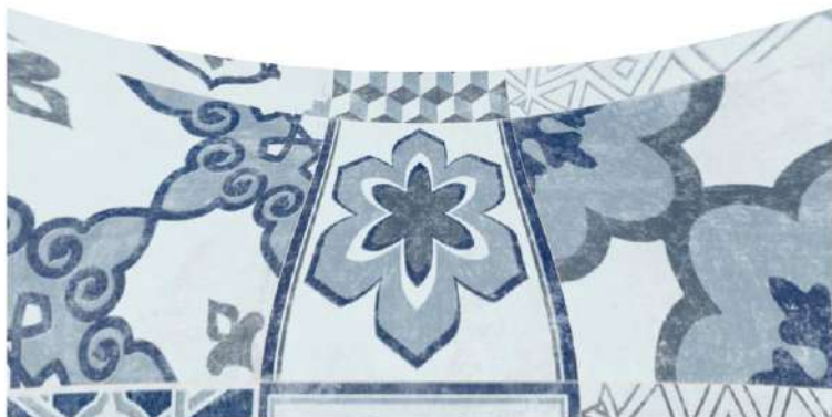
Figura 2.25. Vista frontale. La mappatura sferica di una superficie a doppia curvatura, restituisce una texture deformata prevalentemente nei pressi dei quattro bordi dell'entità.
