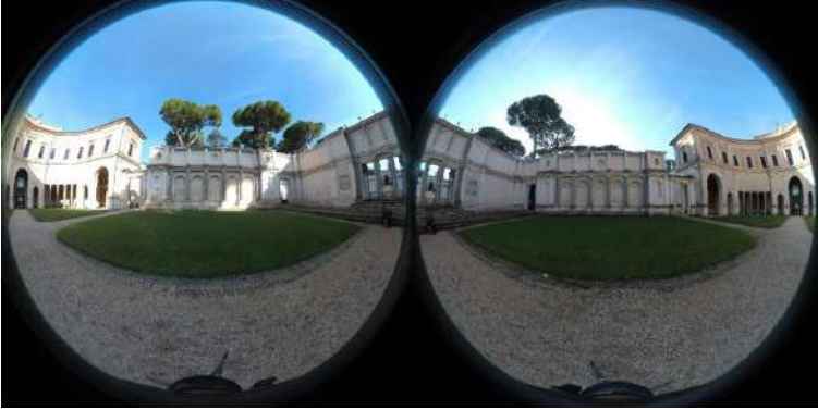
Figura 3.18. Fotogrammi circolari acquisiti con lo scatto della Yi 360 VR restituiti in un'unica immagine .jpg.
