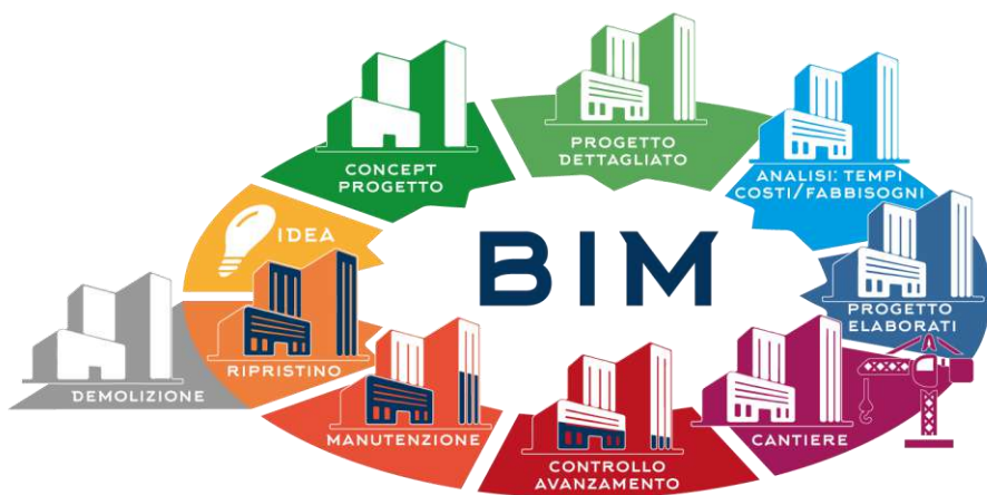
Figura 6.1. Il Building Information Modeling integra nel modello tutte le informazioni che permettono di seguire l'intero ciclo di vita dell'edificio.
