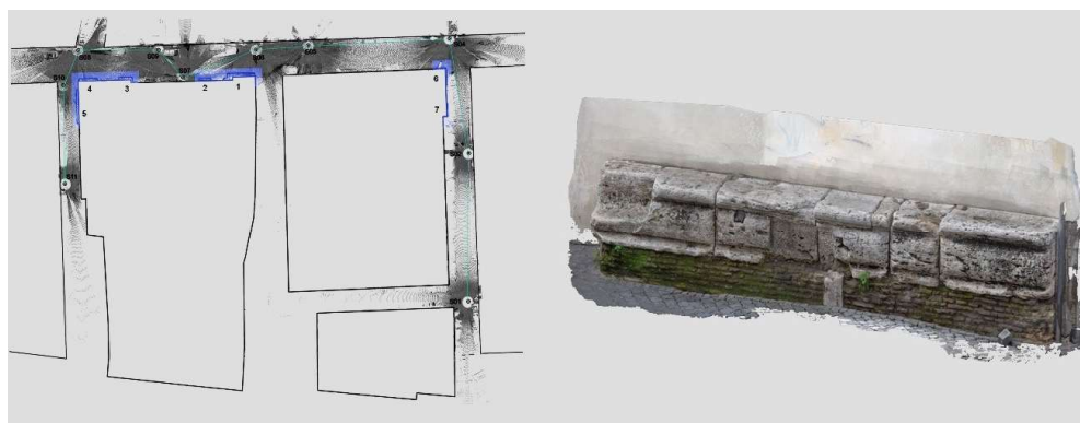
Figura 3. Plano de la nube de puntos de escaneado láser 3D con los fragmentos resaltados y numerados (izquierda). Modelo mesh texturizado a partir del fotomodelado de un fragmento de sillar (derecha).
