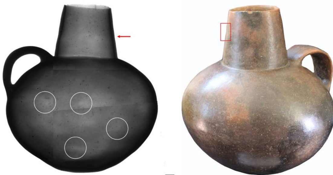
Fig. 5. Radiografia a Raggi X di una brocca in ceramica dalla necropoli di Torre della Chiesaccia. La freccia rossa indica l'altezza dell'anomalia di spessore orizzontale corrispondente al punto di giunzione tra due fasce di argilla sovrapposte per modellare il collo del vaso. I cerchi bianchi evidenziano le anomalie circolari e subcircolari nello spessore del vaso. Il rettangolo rosso sulla brocca a destra indica la leggera depressione orizzontale sul collo del vaso corrispondente all'anomalia visibile nella radiografia a sinistra, evidenziata dalla freccia rossa (la banda nera corrisponde ad 1 cm).
