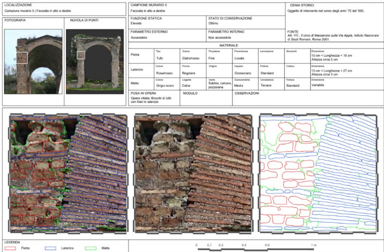
Fig. 11 - Unità Stratigrafica Muraria dell'Arco trionfale presente nel Circo di Massenzio a Roma.
