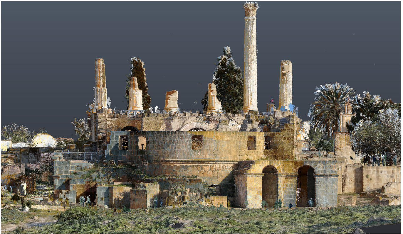
Fig. 6 - Rilievo integrato, TLS + fotogrammetria da drone. Vista del retro del Capitolium di Uthina (elaborazione autori).
