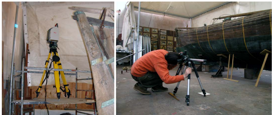
Fig. 2. Fasi di acquisizione delle superfici della barca: a sinistra con laser scanner 3D, a destra con tecnica fotogrammetrica. Elaborazione degli autori.
