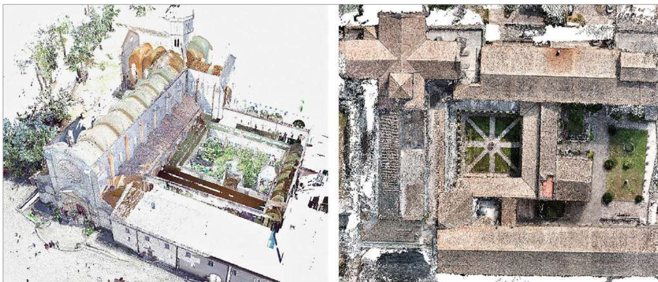
fig. 3 – Abbazie di Fossanova (a sinistra) e di Casamari (a destra). Vista delle nuvole di punti (da scanner laser 3D).
