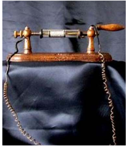
Figura 3: Il coherer, detto anche coesore.
