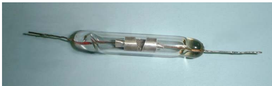
Figura 3: Auto-coherer migliorato di Marconi del 1900.
