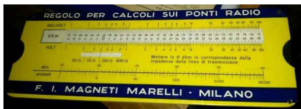
Figura 9: Regolo per determinare la tensione del segnale Vs. l'impedenza di linea per ponti radio FIMM (collezione F. Curcio).
