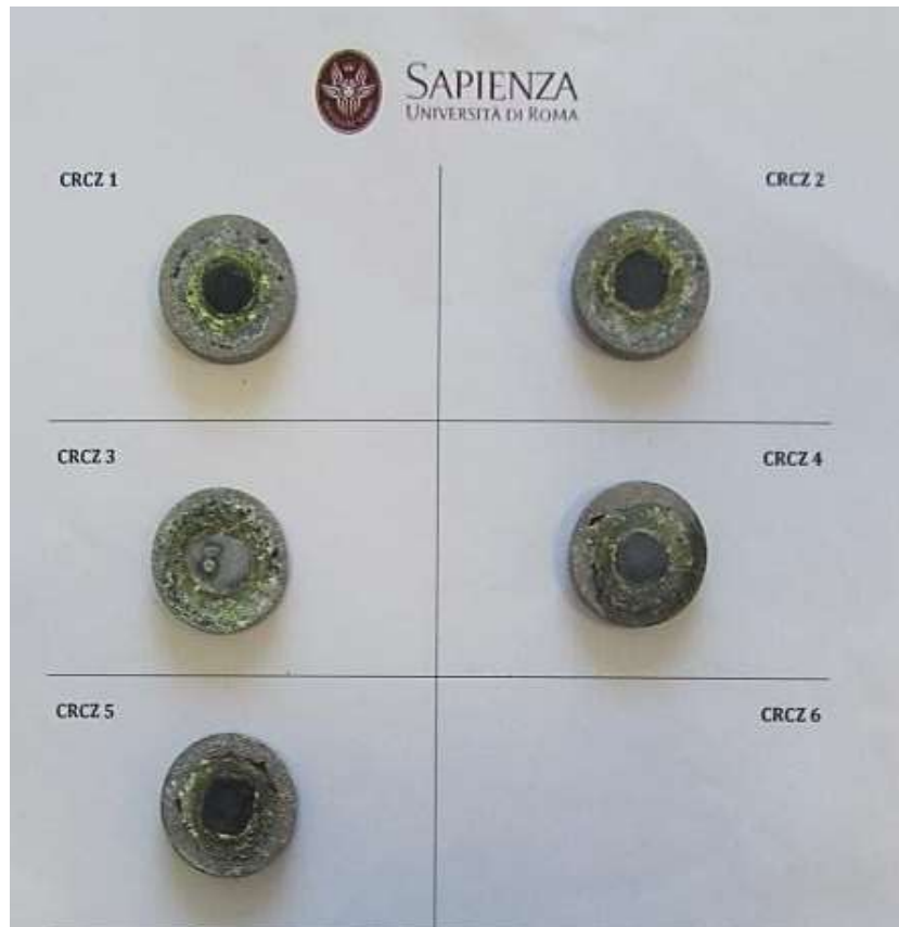
Figura 131: Campioni al termine dell'intera prova di hot corrosion
