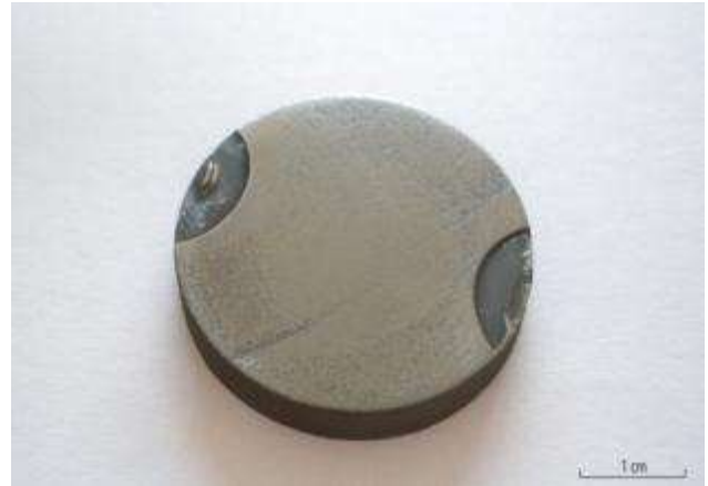
Figura 63: rivestimento WC - CoCrNi sottoposto ad attacco acido: (a) micrografia SEM del campione WCN_SUH3 nella zona corrosa (1000x); (b) micrografia ottica del campione WCN_NIM80A nella zona di transizione tra rivestimento esposto e non esposto alla soluzione acida (100x); (c) campione post-corrosione
