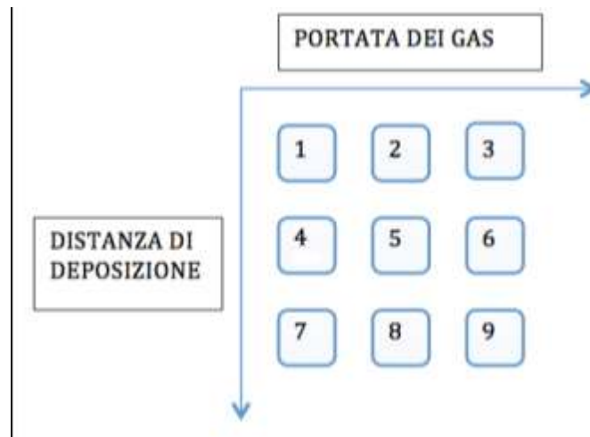
Figura 11: Modello schematico di un'analisi 3 2 , definizione matrice sperimentale
