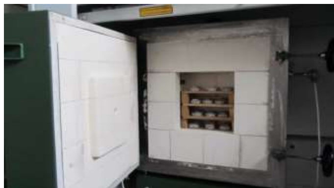
Figura 126: Forno appositamente costruito per la sperimentazione
