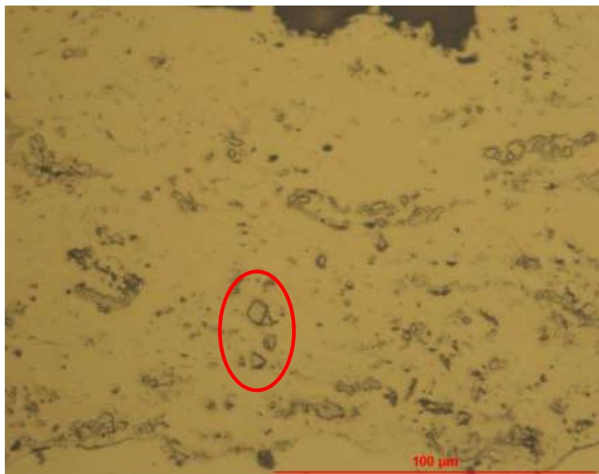
Figura 19: WSF4.1, ingrandimento 50x: particolare dei carburi di tungsteno
