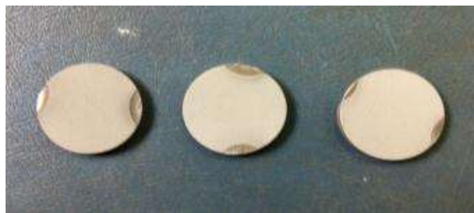
Figura 13: campioni rivestiti con WC - CoCrNi
