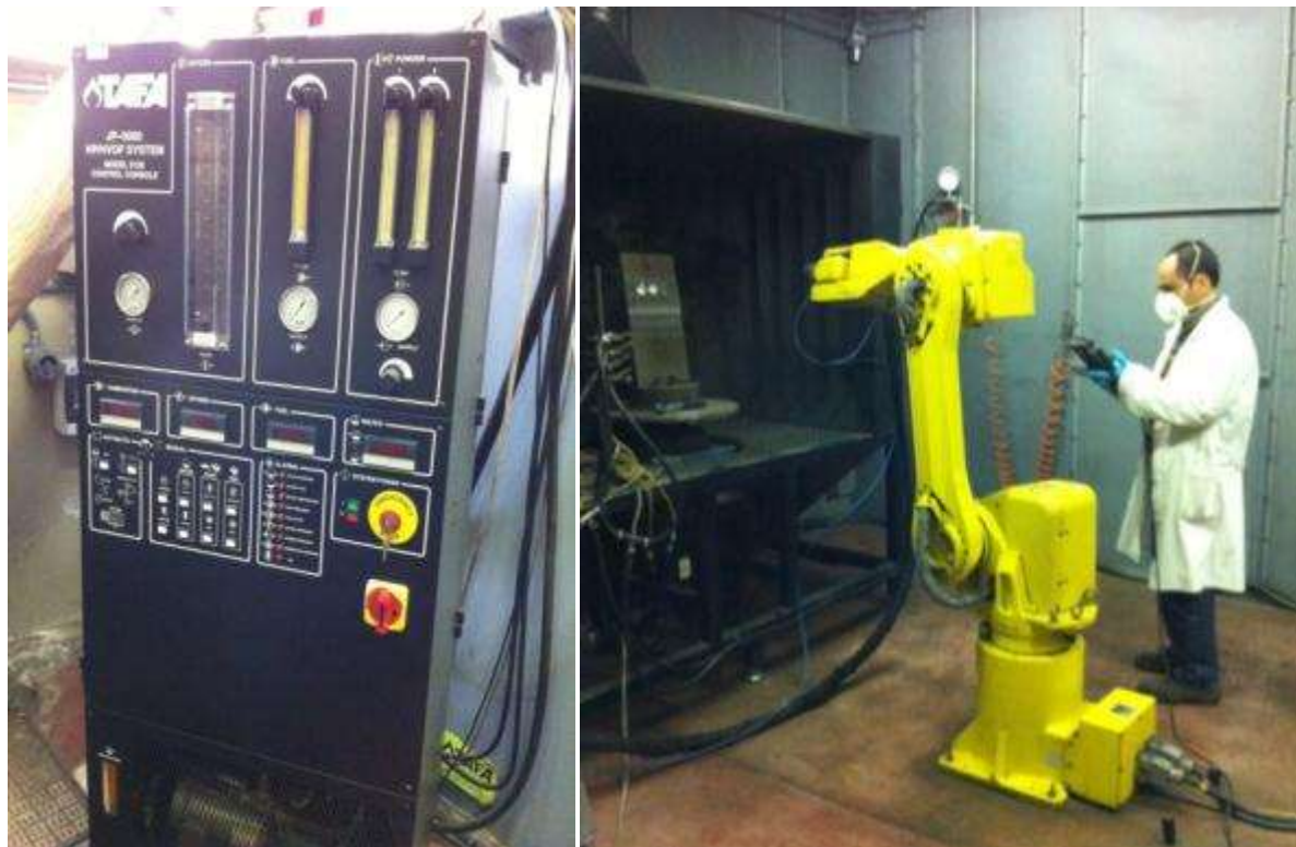
Figura 10: (a) sistema JP-5000 HP/HVOF; (b) braccio robotizzato della torcia Hobart Tafa JP-5000 e i campioni da rivestire assicurati su un supporto
