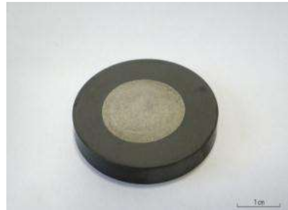
Figura 69: rivestimento PVD WC/C: (a) micrografia SEM del campione WC/C_SUH3 nella zona di transizione tra rivestimento esposto e non esposto all'attacco acido (3500x); (b) campione WC/C_NIM80A post-corrosione
