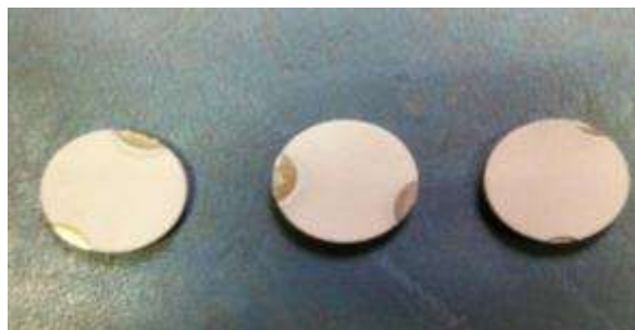
Figura 12: campioni rivestiti con Cr_3C_2 - 25(NiCr)
