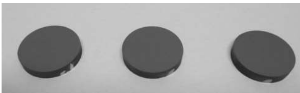
Figura 84: campioni rivestiti in Cr_3C_2 - CoNiCrAlY
