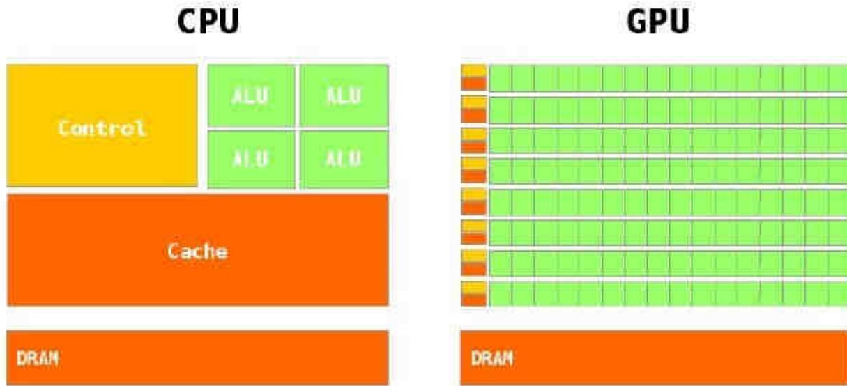
Figura 65 – Confronto architetturale alto livello tra CPU e GPU
