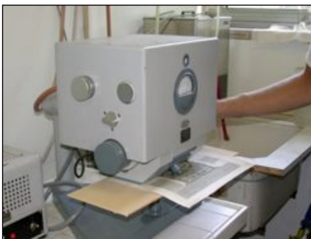
Figura 10 – Il riflettometro Elrepho Zeiss durante la misurazione di una delle incisioni a bulino di Jacopo Lauro.
