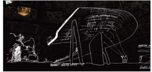
fig. 5.24 - “Nova Erigere Vetera Servare 753” – capogruppo: Salvador Perez Arroyo. Si propone una passerella aerea ad anello, su pilastri leggeri, con lo scopo di coniugare astrattamente nuovo e antico.
