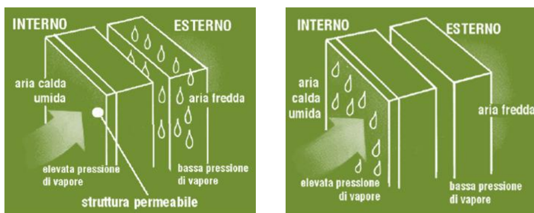
FIG.17 - Fenomeni di condensa interstiziale e superficiale;
