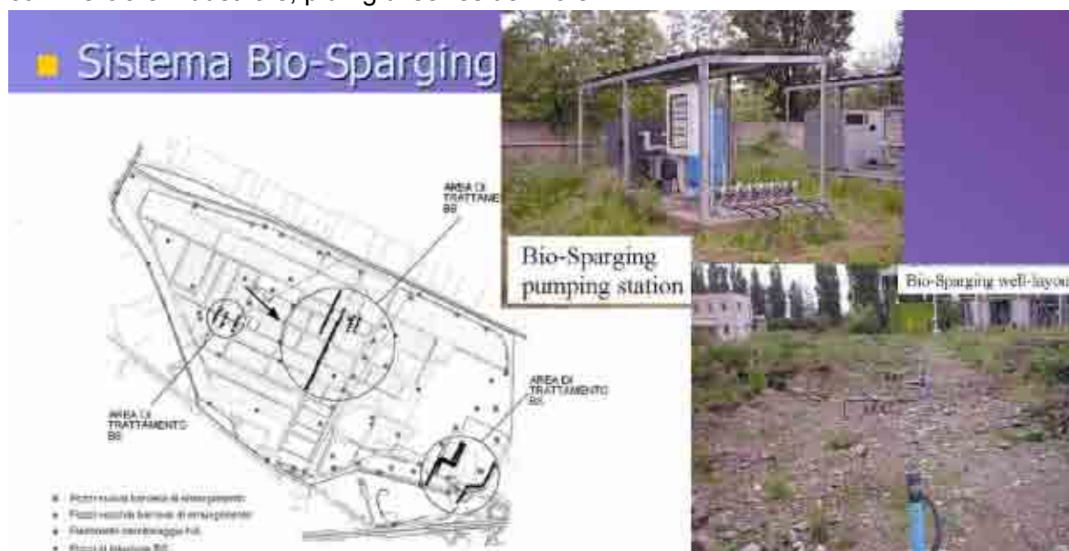
Fig.C2- 6: Schema del sistema di bonifica adottato
