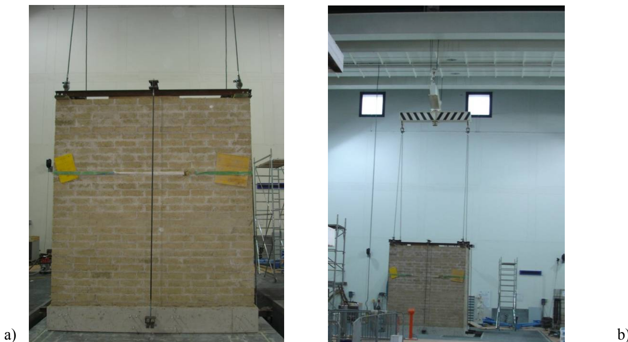
Figura C- 11. Movimentazione del campione.
