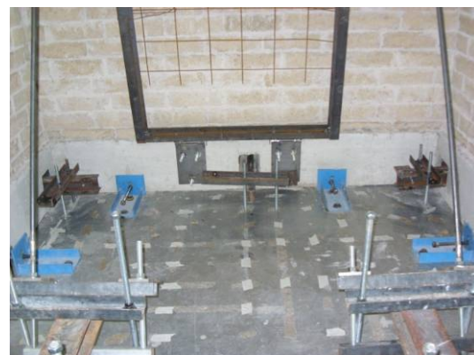
Figura C- 13. a) Ancoraggi del cordolo posteriore. b) Dettaglio dei “tacchi” azzurri interni.
