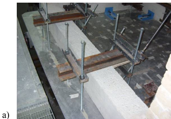
Figura C- 13. a) Ancoraggi del cordolo posteriore. b) Dettaglio dei “tacchi” azzurri interni.
