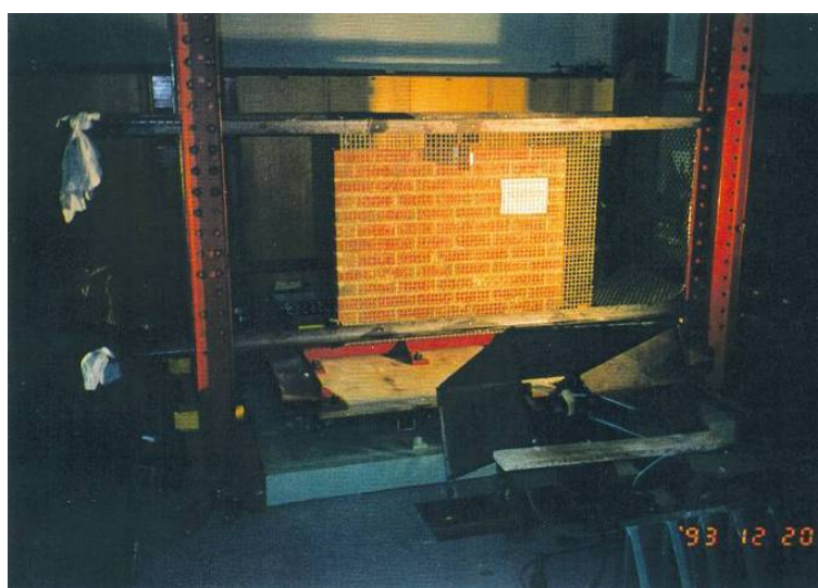
Fig. 2-15. Prove sperimentali su parete singola. Da Lam et al. (1995).
