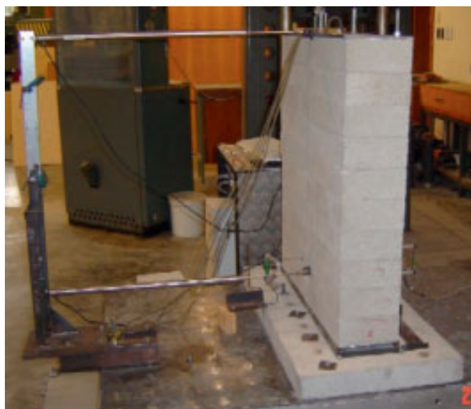
Fig. 2-20. Prove di oscillazione libere. Da ElGawady et al. (2011).
