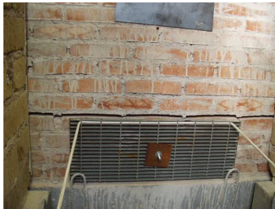
Figura A-13. Creazione di un campione di altezza ridotta. La formazione di una nuova lesione viene ottenuta vincolando la porzione di base della parete.
