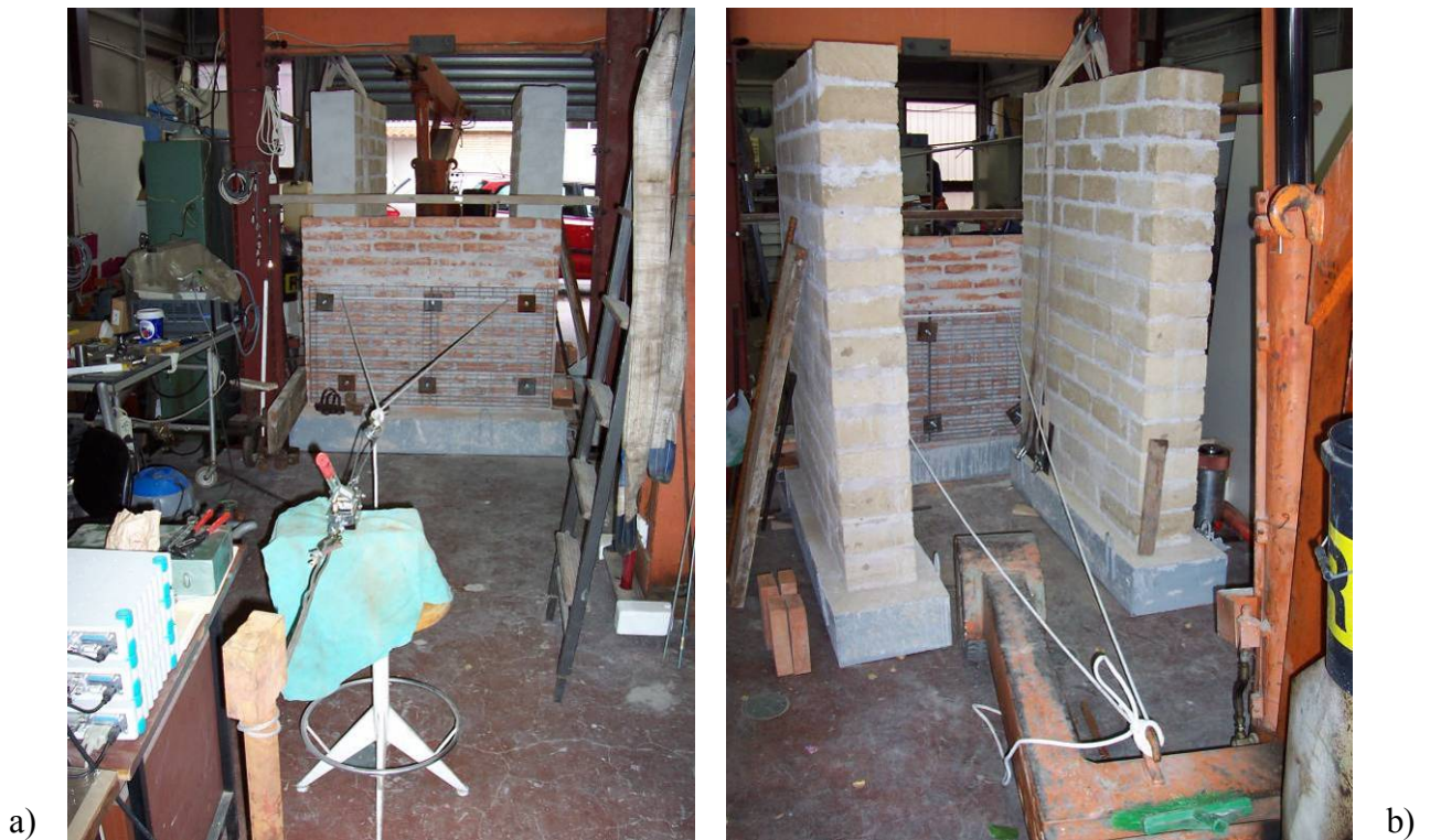
Figura A-7. Fessurazione alla base del campione n.1. a) faccia anteriore tirata da argano a leva; b) faccia posteriore con funi di sicurezza.
