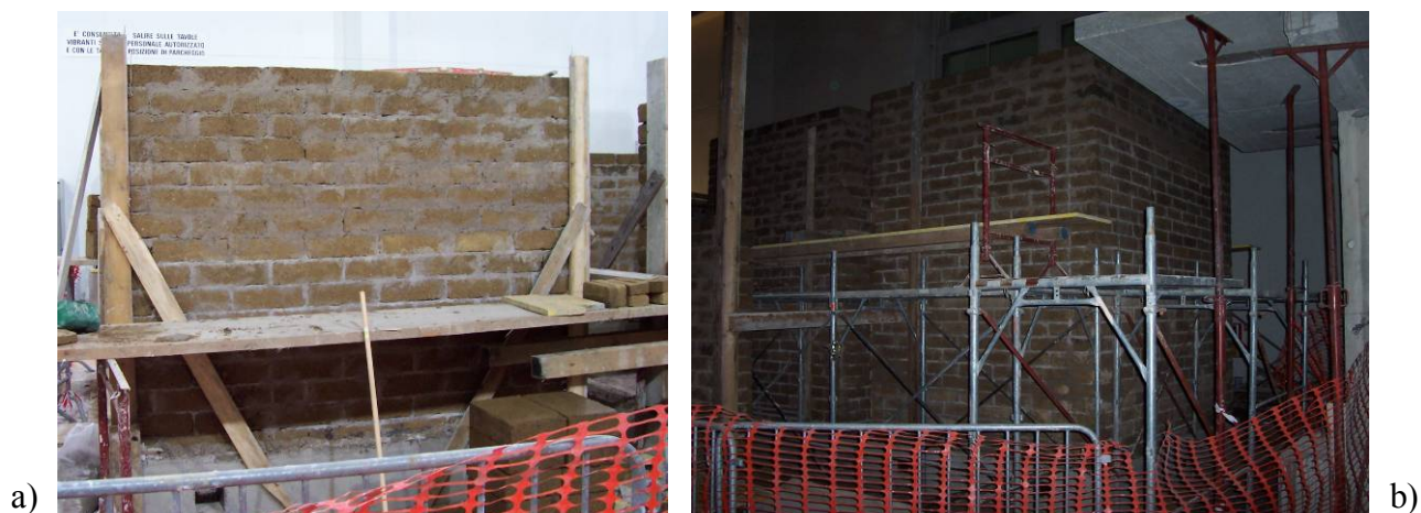
Figura C- 3 Campioni con pareti di controvento: a) in fase di costruzione; b) ultimati. I campioni sono due: uno con facciata ammorsata e l'altro con facciata accostata. Di quest'ultimo si è riferito nel presente tesi.
