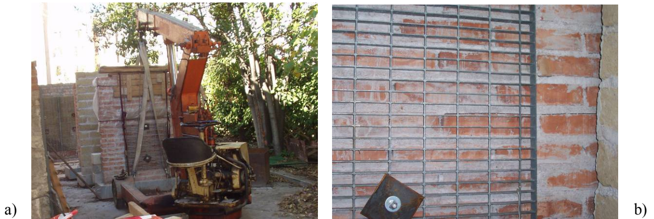
Figura A-6. Il campione 2 placcato con grigliati tipo Keller, a seguito di un lesionamento accidentale. a) fase preliminare di movimentazione; b) grigliato a cavallo della lesione.
