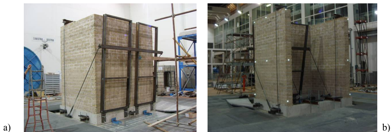
Figura C- 27. Vista del campione prima dell'inizio delle prove. a) esterno facciata e muro trasversale sx; b) interno facciata e muro trasversale sx, esterno muro trasversale dx, si notino i marker illuminati.
