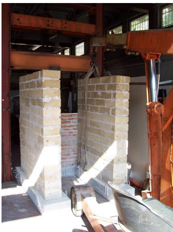
Figura A-12. Posizionamento di facciata, di laterizi, e muri trasversali, di tufo.
