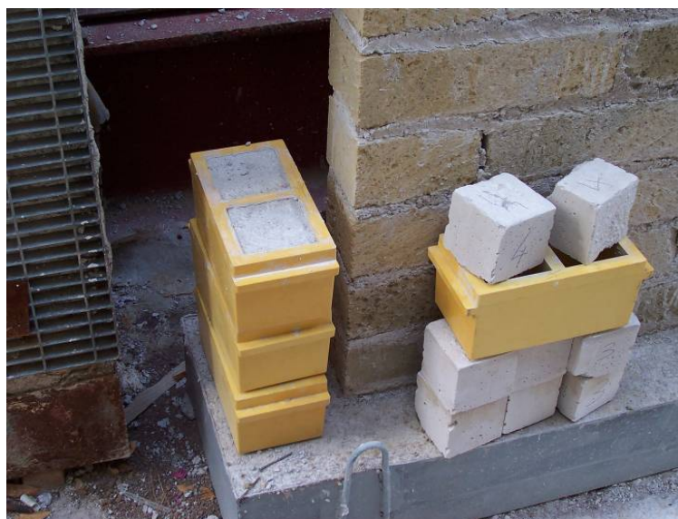
Figura A-4. Campioni di malta per prove di schiacciamento.
