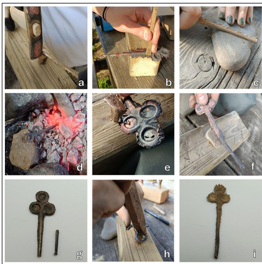
Fig. 18 Fasi della produzione degli spilloni a tre anelli
