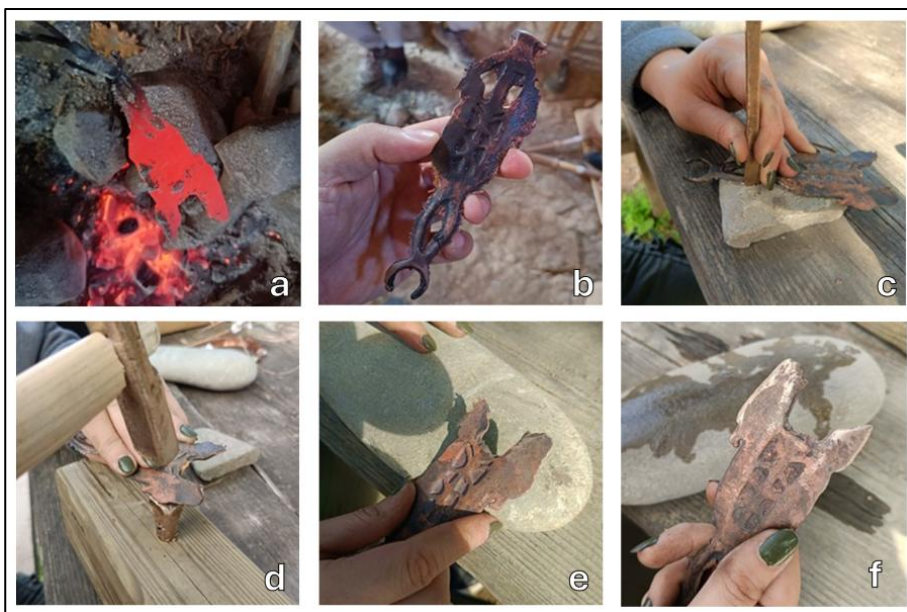
Fig. 21 Fasi della produzione del rasoio
