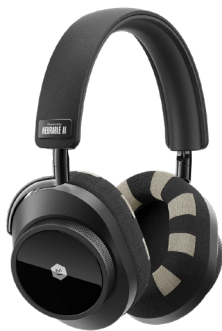
Fig. 5. MW75 Neuro sono le prime cuffie di livello consumer ad integrare sensori EEG e tecnologia BCI, consentendo di monitorare i livelli di concentrazione e fornire informazioni sull'attività cerebrale con un fattore forma largamente diffuso. [© Neurable]
