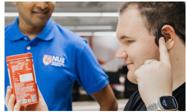
Fig. 29. AISee incorpora un assistente AI in grado di leggere il mondo circostante e descriverlo in tempo reale con linguaggio umano naturale. [© Augmented Human Lab]
