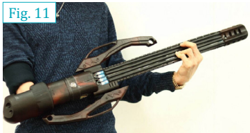
Fig. 11. MusiArm integra una chitarra funzionante nel fattore forma della protesi per arto superiore. [© KMD Embodied Media]
