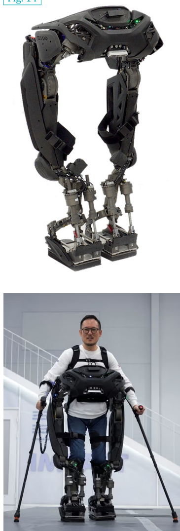
Fig. 14. Il WalkON Suit F1 si configura come la combinazione di un robot umanoide e un esoscheletro attivo. [© KAIST]
