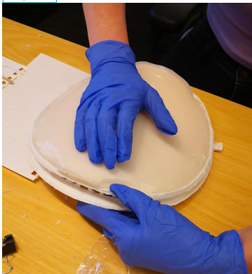
Fig. 7. Incollaggio della componente bi-strato in silicone alla componente rigida del Womb Core. [© Camilla Gironi]
