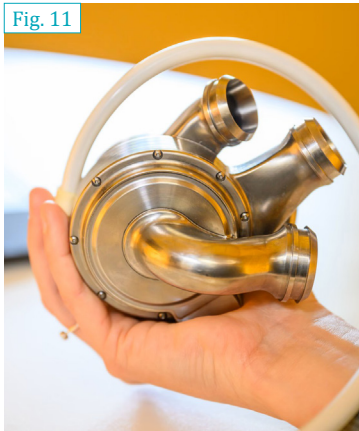
Fig. 11. Il BiVACOR utilizza un singolo rotore bifacciale, fatto levitare e ruotare da un motore elettromagnetico per pompare il sangue sia nella circolazione sistemica che in quella polmonare. Questo design mira a ridurre al minimo l'usura e i traumi ematici grazie alla sospensione senza contatto e agli ampi spazi vuoti. [© Claire Usmar/BiVACOR]
