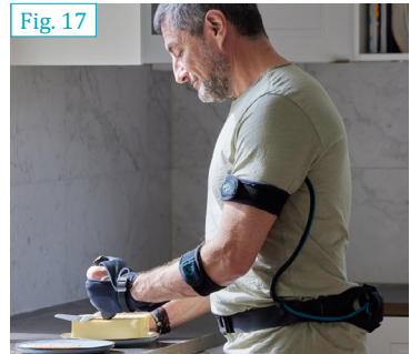
Fig. 17. Carbonhand si basa su materiali flessibili e tessuto per una indossabilità confortevole. [© Bioservo]
