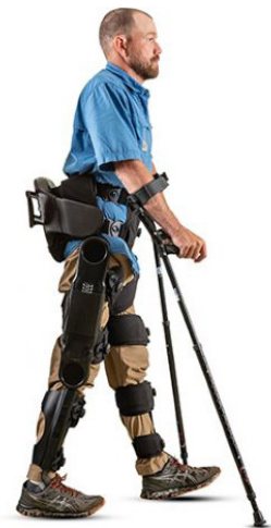
Fig. 15. Il WalkON Suit F1 si configura come la combinazione di un robot umanoide e un esoscheletro attivo. [© KAIST]
