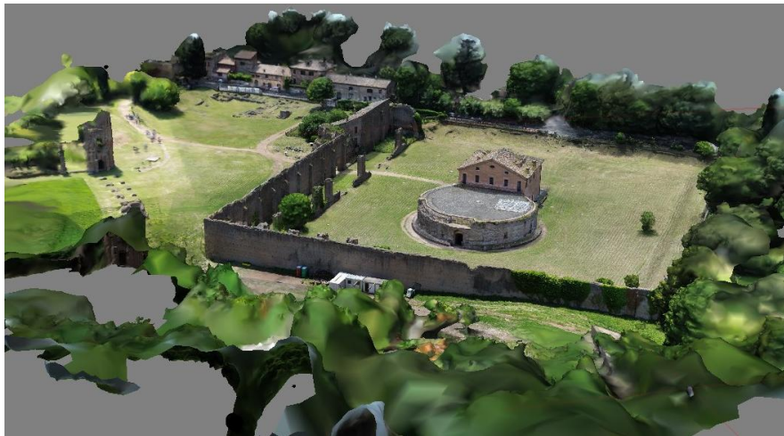
Fig. III.1: Modello aereo ottenuto processando le fotografie scattate da drone (DJI Mini 3) e realizzato con il software Agisoft Metashape . (R. Santarelli 2025)
