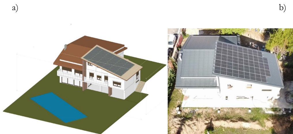
Figura 33. a) Modello 3D dell'impianto fotovoltaico (vista sud); b) Immagine fotografica dell'impianto fotovoltaico sul tetto dell'edificio ristrutturato.
