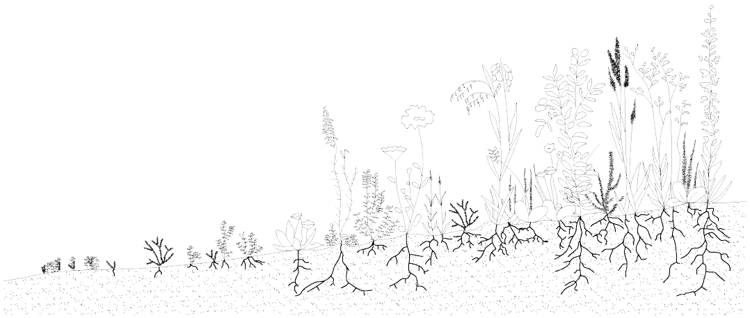
5.8. Lo schema mostra la relazione tra lo spessore del substrato che varia da +8cm a +30cm e la vegetazione.
