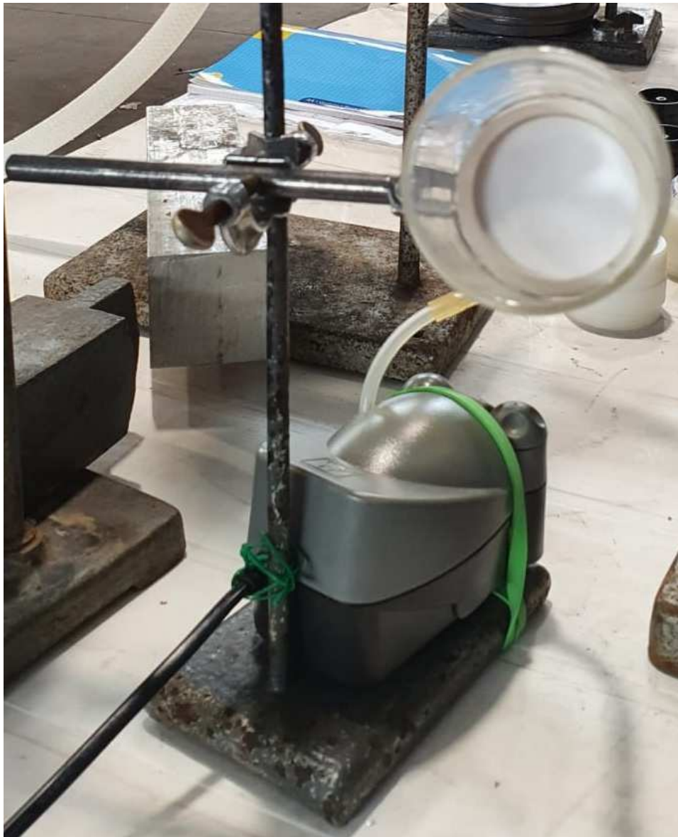
Figura 28: sistema di campionamento del pulviscolo atmosferico
