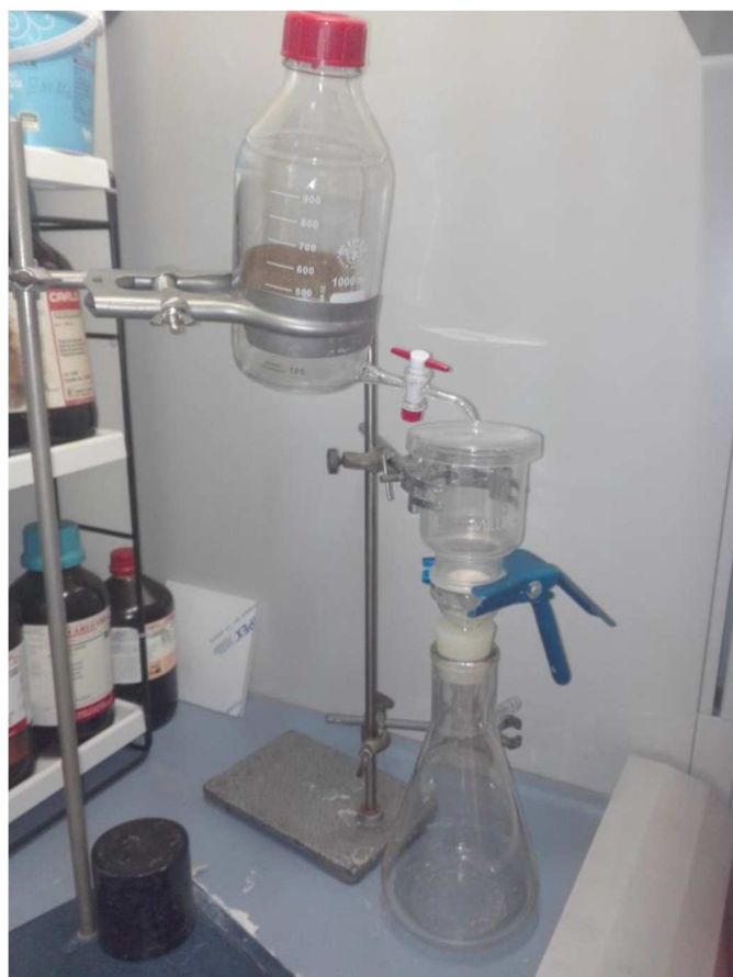
Figura 7: sistema filtrante, la soluzione fluisce dalla bottiglia alla beuta da vuoto passando per il filtro alla base del “bicchiere”
