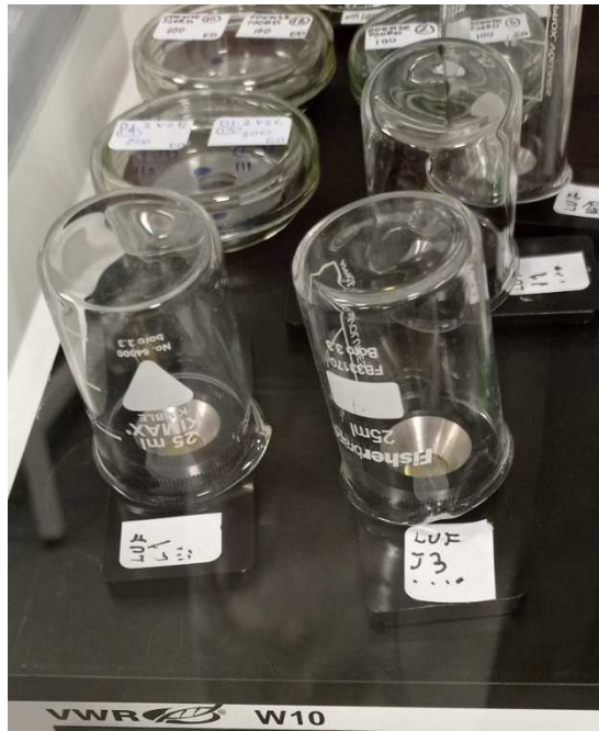
Figura 25: sistema di deposizione per l'imaging FT-IR
