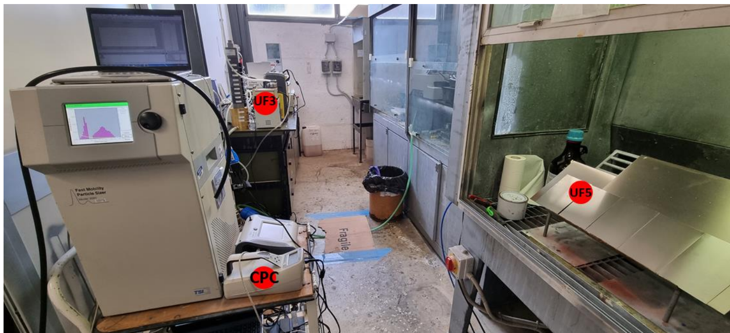
Figura 61 Disposizione degli strumenti all'interno del laboratorio: UF5= sull'operatore, UF3= lato sinistro. CPC= posizione centrale (DEMO 1).
