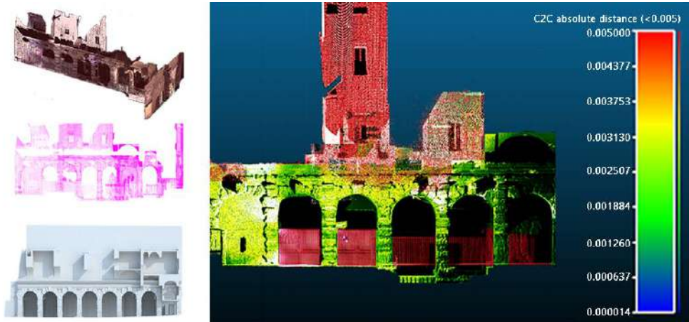
Fig. 6/ Valutazione della distanza metrica tra modello numerico e HBIM del Tempio del divo Claudio a Roma.
