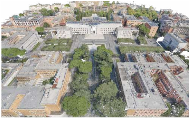
Fig. 26/ Nuvola di punti della Città Universitaria derivante da acquisizione tramite UAV. Vista verso il Rettorato (in alto), vista verso i Propilei di ingresso (al centro), vista verso la Cappella della Divina Sapienza e l'Edificio di Fisica (in basso).
