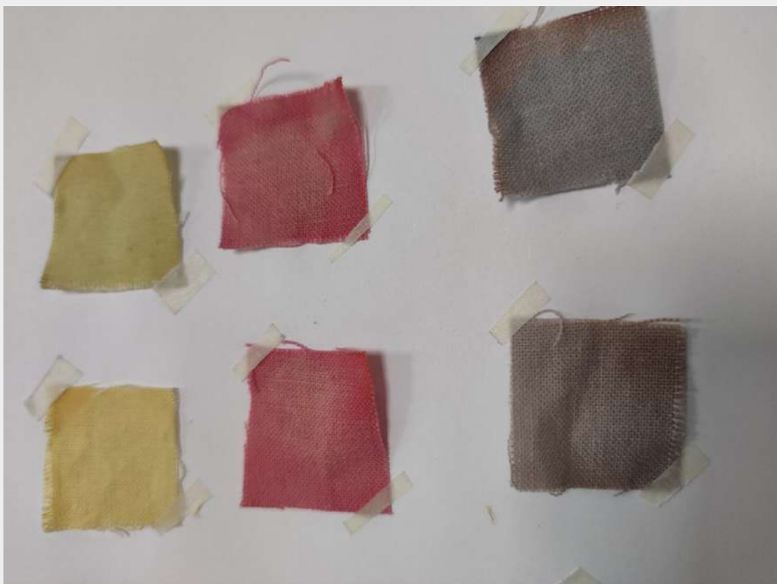
#Fig.35_ La Figura mostra con più evidenza le aree scolorite dai batteri. In particolare nel colore Nero è particolarmente visibile il processo di Sottrazione di colore sintetico ed Addizione di colore naturale organico. Nel campione nero in alto a destra è possibile osservare una differenza nelle tonalità dello scolorimento. Lungo il bordo superiore il colore tende al marrone-rosso, mentre nella zona centrale il colore è più freddo, a causa della Piocianina (verde-blu) prodotta dai batteri che ha a sua volta tinto il campione.
