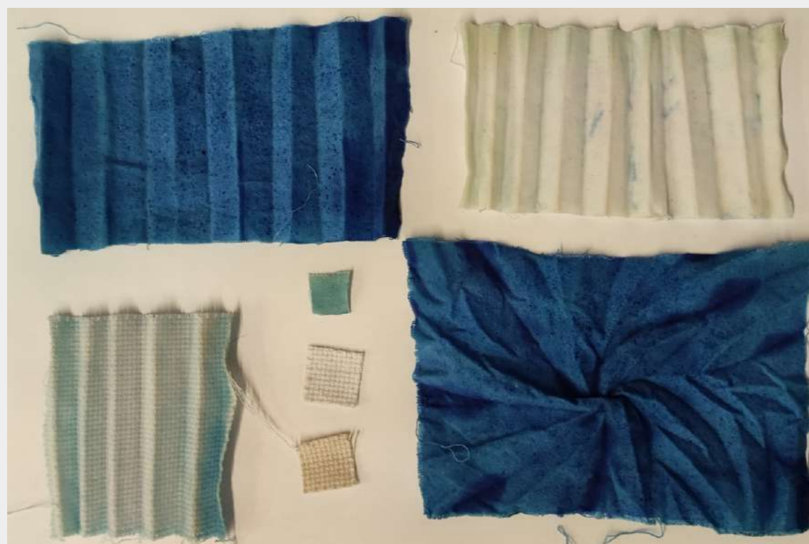
#Fig.38_ Prove di texturizzazione. Campioni tinti con Blu di Metilene e sottoposti a scolorimento e tintura tramite P.a.
