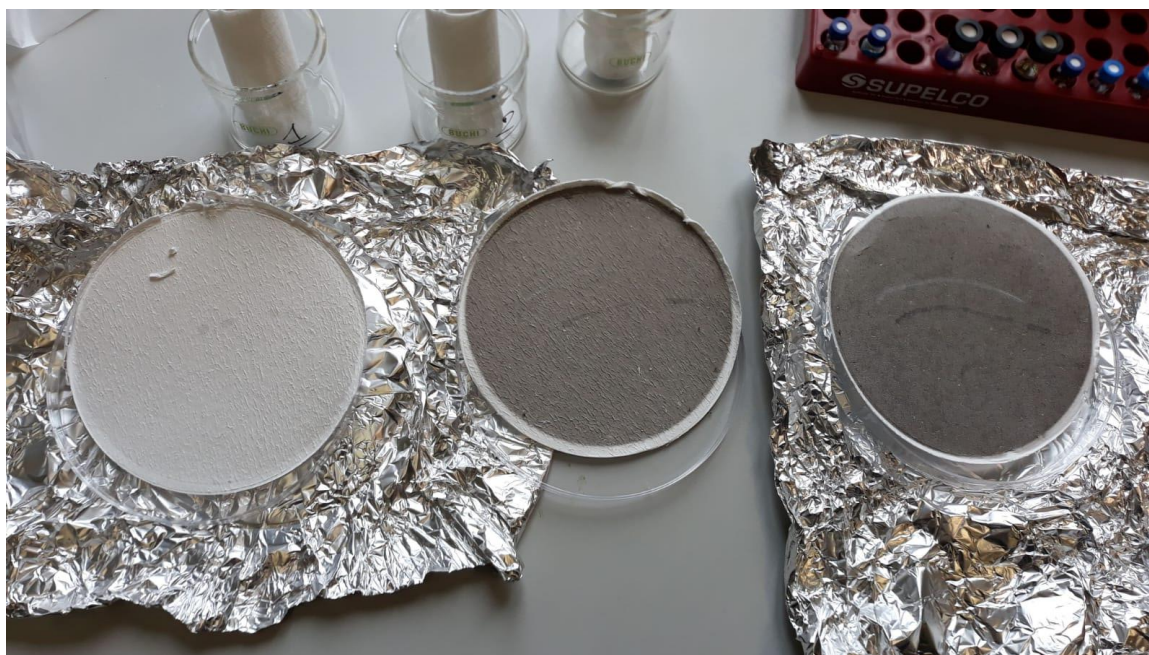
FIGURA 10 – FILTRI IN FIBRA DI QUARZO DOPO CAMPIONAMENTO
