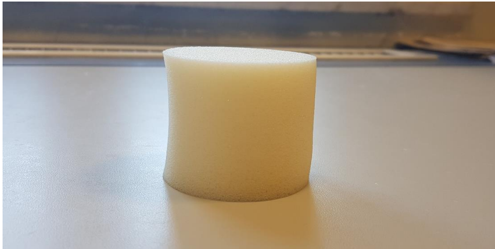
FIGURA 11 – CILINDRO DI SCHIUMA POLIURETANICA (PUF) UTILIZZATO PER IL CAMPIONAMENTO DELLA FRAZIONE COLATILE
