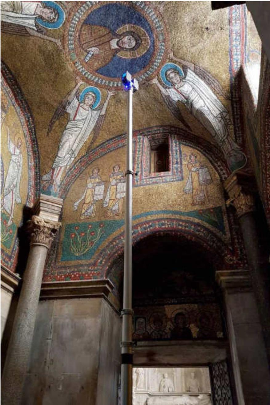
3.7 Roma, Santa Prassede, oratorio di San Zenone (2018), Laser scanner montato direttamente su un'asta pneumatica in grado di elevarlo ad una quota di circa 6 m; rovesciando lo strumento con apposita modifica è possibile effettuare riprese dei piani pavimentali o del territorio circostante
