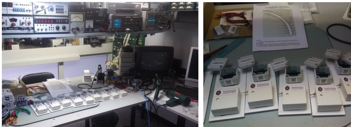
Figura 5.26: fase di preparazione dei Beacon in laboratorio; realizzazione e assemblaggio dei 18 supporti luminosi
