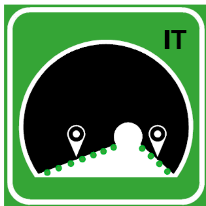
Figura 5.56: esempio di segnaletica di una galleria stradale dotata di sistema di localizzazione a livello delle banchine
