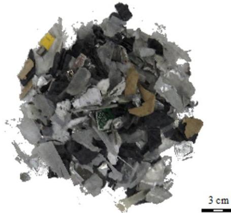
Figura 4.1.8. Foto digitale del campione analizzato composto da monitor a schermo piatto EoL, proveniente da una linea di comminuzione di un impianto di trattamento RAEE.
