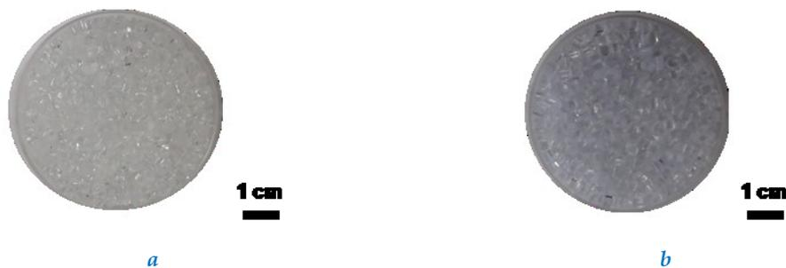
*Figura A - 5. Plastiche vergini in pellet utilizzate per l'addestramento del modello PLS-DA: a) PMMA e b) PC.*
