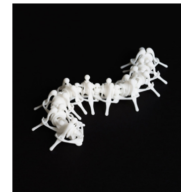
“Ready to Crawl” dalla mostra Parametric Move (Tokyo, 2018). Si tratta di oggetti stampanti in 3d “pronti”, senza necessità di assemblaggio. L'unico elemento aggiunto successivamente è un motore stepper, che dà il soffio vitale a queste “creature”.
