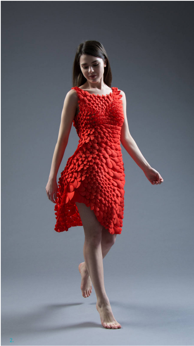
1. - 2. Nervous System: Petal Dress ottenuto con il sistema algoritmico Kinematics. L'intero vestito è stampato in 3D in Nylon con tecnologia SLS. Il sistema di interlocking dei petali permette di muoversi liberamente. 3. - 4. . Nutella Unica: campagna pubblicitaria basata su grafica generata algebricamente: 7 milioni di barattoli unici, ognuno con il proprio gemello da scovare. 5. - 6. Zomparelli (Code-It) con il progetto Carapace immagina come si adatterà lo scheletro umano quando la tecnologia sostituirà completamente i tradizionali sistemi di comunicazione: risp. Audiam e Vidiam.
