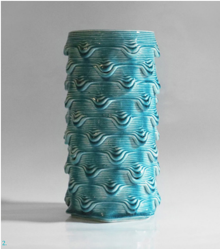
1. - 2. Due vasi del progetto Clay Code (Zomparelli e De Masi) che sfrutta procedure generative (svolte all'interno del software Blender3D) di manipolazione diretta del gcode per la stampa 3D. 3. - 4. Il laboratorio di Oliver Van Herpt e alcuni vasi realizzati con la stampante 3D FDM da lui modificata per la stampa in argilla. 5. - 6. - 7. - 8. Varie sperimentazioni condotte dal prolifico Teakyeom.
