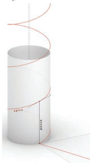
Fig. 21/ Genesi geometrica di un'elica cilindrica e suo sviluppo piano.
