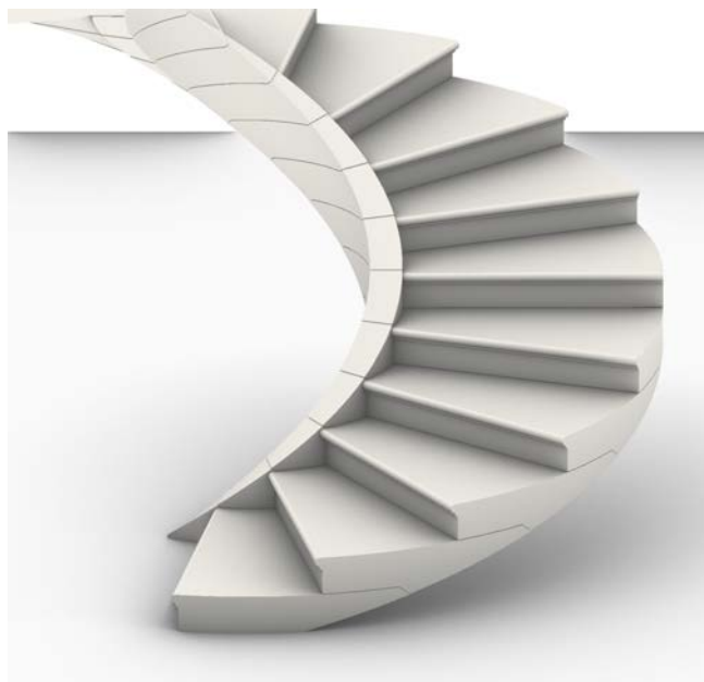
Fig. 22/ Apparecchio stereotomico di una scala elicoidale.
