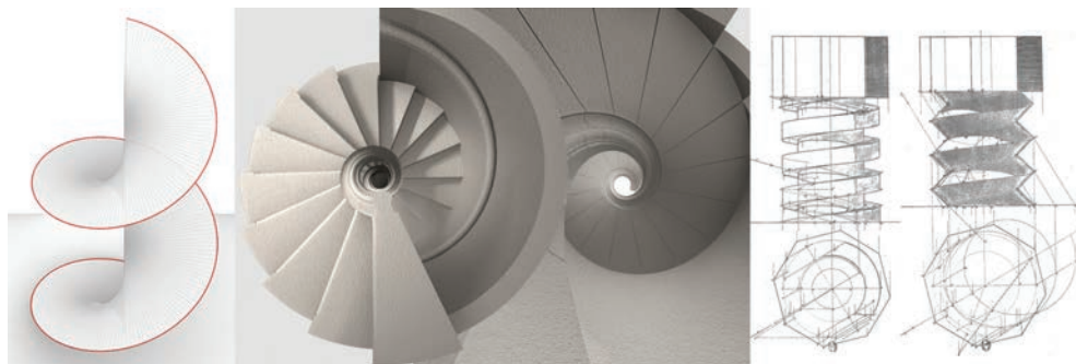
Fig. 20/ Eliche cilindriche nelle scale elicoidali e nelle viti; planches tratte dal Traité de stereotomie di C. F. A. Leroy, ed. 1877.
