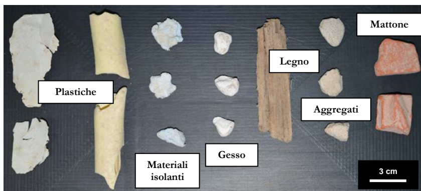
Fig. 5 - Esempio di immagine acquisita per addestrare il modello di classificazione. Classi di materiali: aggregati, mattone, materiali isolanti, gesso, plastica e legno.
