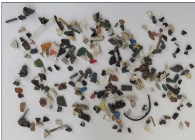
Fig. 3 - Esempio di un campione di RAEE (i.e. particelle comprese nell'intervallo dimensionale tra 2 e 0.5 mm) risultante da azioni di comminuzione e successiva classificazione.
